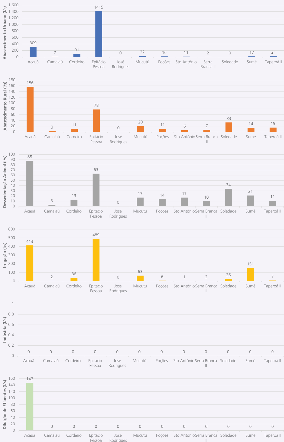
Figura 4.4 - Demandas Hídricas de Retirada e Vazões de Diluição por Reservatório - Sistemas de Reservatórios da Bacia do Rio Paraíba
