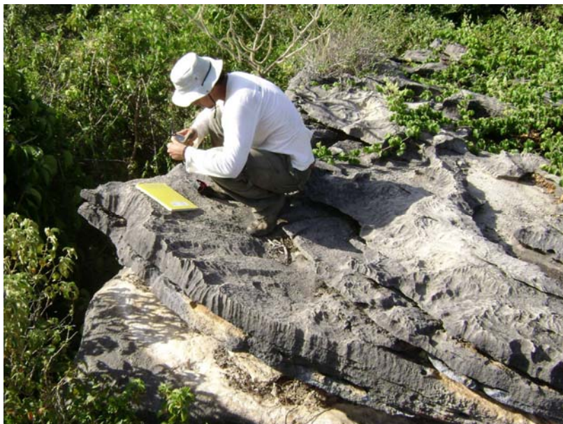
Foto 2.11 – Camadas inclinadas da Formação Jandaíra (160Az/20°/NE), borda noroeste da Chapada do Apodi, Lajedo Largo em Jaguaruana - CE (ANA-52; 641339, 9456841).
