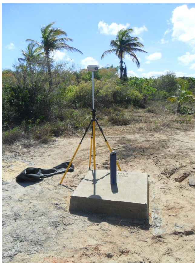
PO-02 Nísia Floresta - nivelamento topográfico com GPS geodésico
