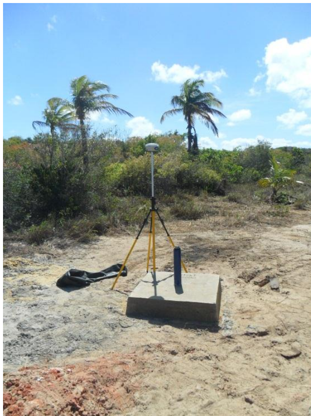
PO-01 Nísia Floresta - nivelamento topográfico com GPS geodésico
