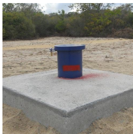
Foto 2. PE de Nisia Floresta concluído, tubo de fechamento e marca da ranhura do nivelamento topográfico
