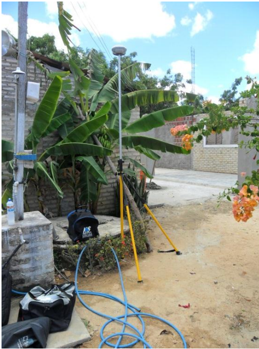
Foto 19. Nivelamento topográfico com GPS Geodésico em poço cacimba
