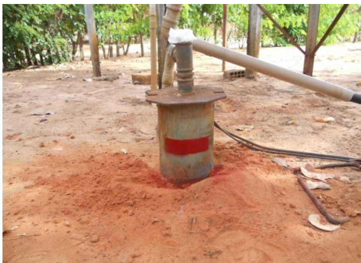
Foto 15. PO-02 Loteamento Caminho do Mar – Extremoz: poço existente utilizado como poço de observação e marca da ranhura do nivelamento topográfico
