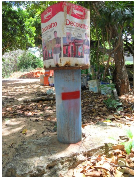
Foto 20. Destaque da sinalização do entalhe do nivelamento topográfico
