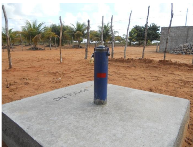
Foto 14. PO-01 Loteamento Caminho do Mar – Extremoz: acabamento construtivo e marca da ranhura do nivelamento topográfico
