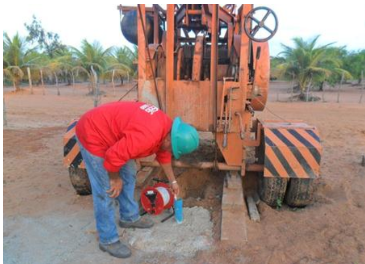
Foto 18. Medição do nível de água no PO-01 do teste 3
