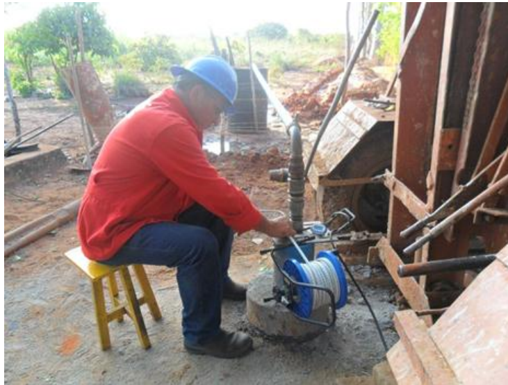
Foto 17. Medição do nível de água no PE do teste 3
