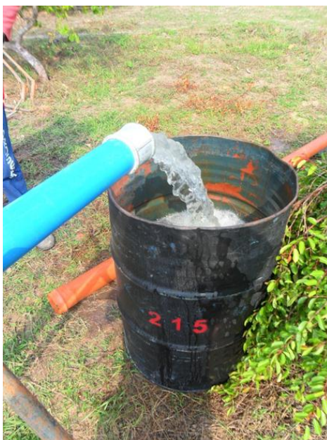
Foto 16. Medição de vazão dos testes de aquífero com tambor aferido 215 L
