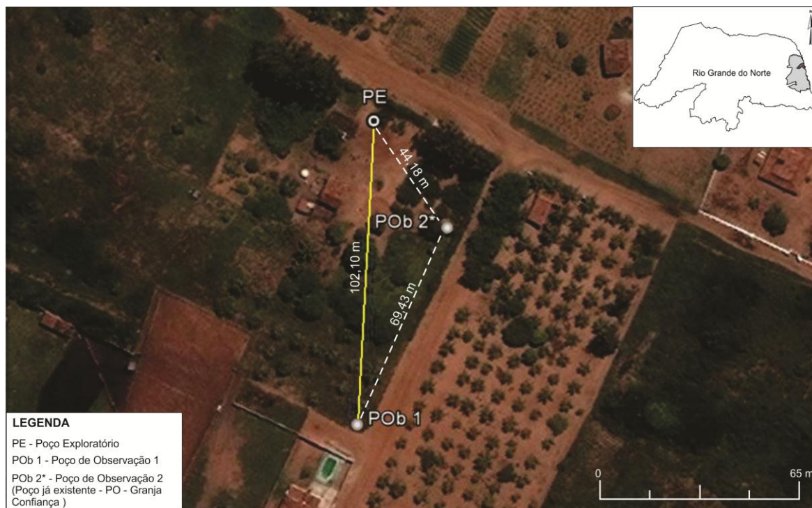
Figura 6.11. Croqui de localização dos poços perfurados e pré-existentes em Extremoz – Loteamento Caminho do Mar
