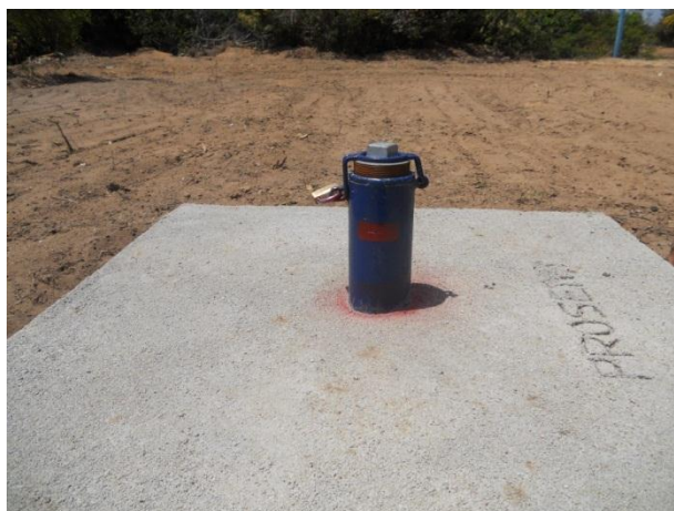
Foto 11. PO-02 Fazenda São Mateus - Ceará-Mirim: acabamento construtivo e marca da ranhura do nivelamento topográfico
