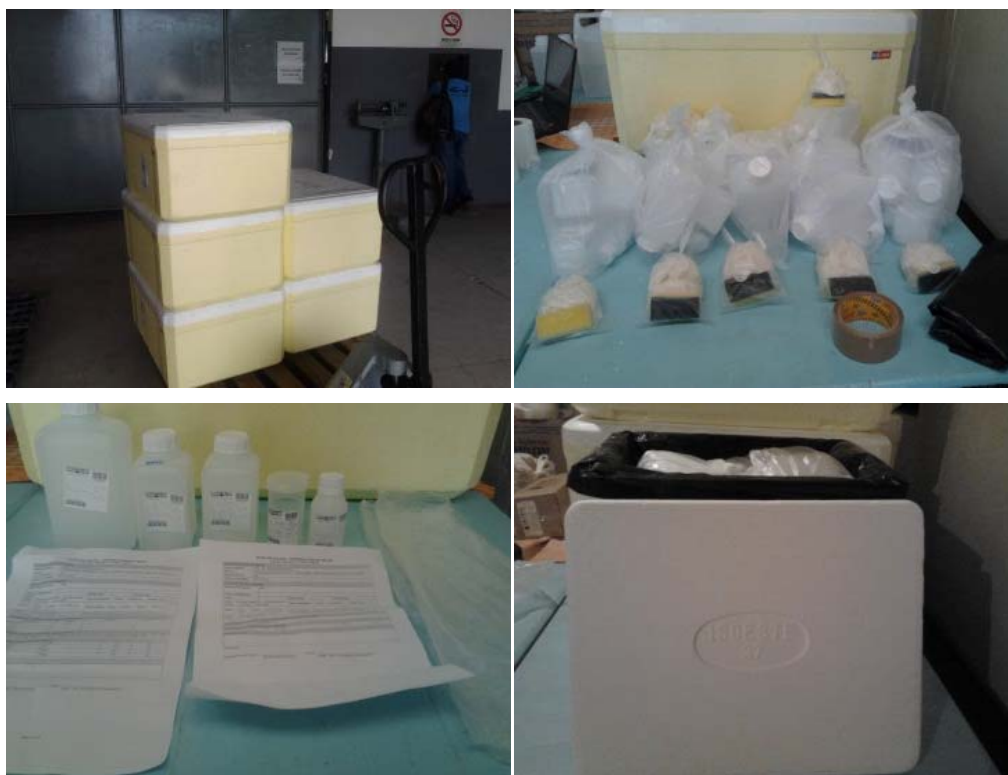
Foto 5.1 – Kit's de coletas usados em campo para as amostragens de água do aquífero Rio Branco, nas duas campanhas, na cidade de Rio Branco - AC.
