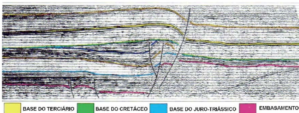
Figura 1.41 – Na seção sísmica na Bacia do Acre se observa que inicialmente o embasamento foi bastante rebaixado por falha normal no lado oeste, provocando espessamento das formações no bloco baixo. Depois o bloco baixo foi soerguido através de falhamento inverso devido aos esforços compressivos da Orogênese Andina (Fase Quéchuá). O refletor superior alaranjado corresponde à Formação Pozo do Oligoceno-Eoceno do Peru, unidade esta que no Brasil ainda não foi nomeada ou estudada. Fonte Petrobras.
