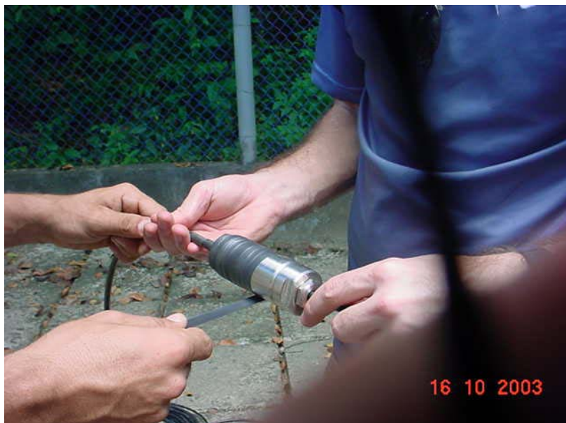
Figura 19.1 – Sensor de profundidade de nível sendo impermeabilizado por fita isolante para evitar vazamento de corrente no contato com o fio.
