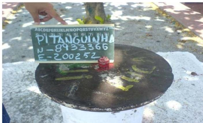
**Figura 7.11** - Poço sem bomba em que foi colocado o tubo guia (em vermelho) para medição do nível estático.
