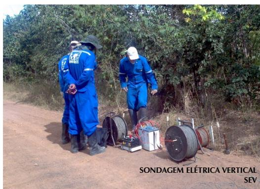
As SEVs foram executadas em arranjo *Schlumberger*, com espaçamento máximo de  $AB/2$  de 2 mil metros, com exceção da SEV-99 que teve um espaçamento máximo de 1 mil metros, o que permitiu investigar uma profundidade teórica máxima aproximada de 700 e 300 metros, respectivamente. Na prática, essa profundidade dependeu do contraste entre as resistividades das camadas geoeletricas. As interpretações das SEVs
