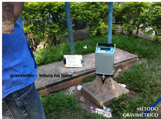
Os dados gravimétricos foram adquiridos em 200 estações distribuídas em uma malha com espaçamento de 30 km entre cada ponto, com posições coincidentes com os pontos de ensaio de TDEM.
