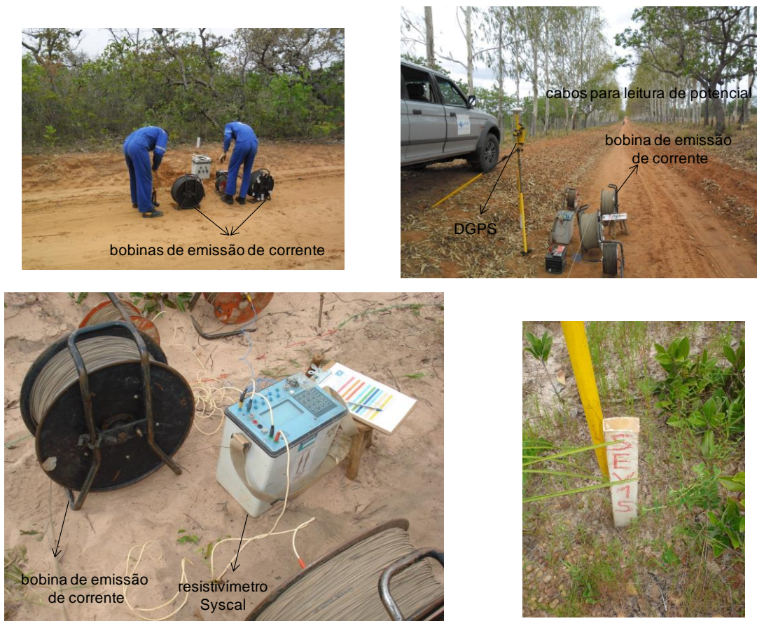
Figura 5.1 – Fotos ilustrando o levantamento geofísico por meio da técnica de sondagem elétrica vertical.
