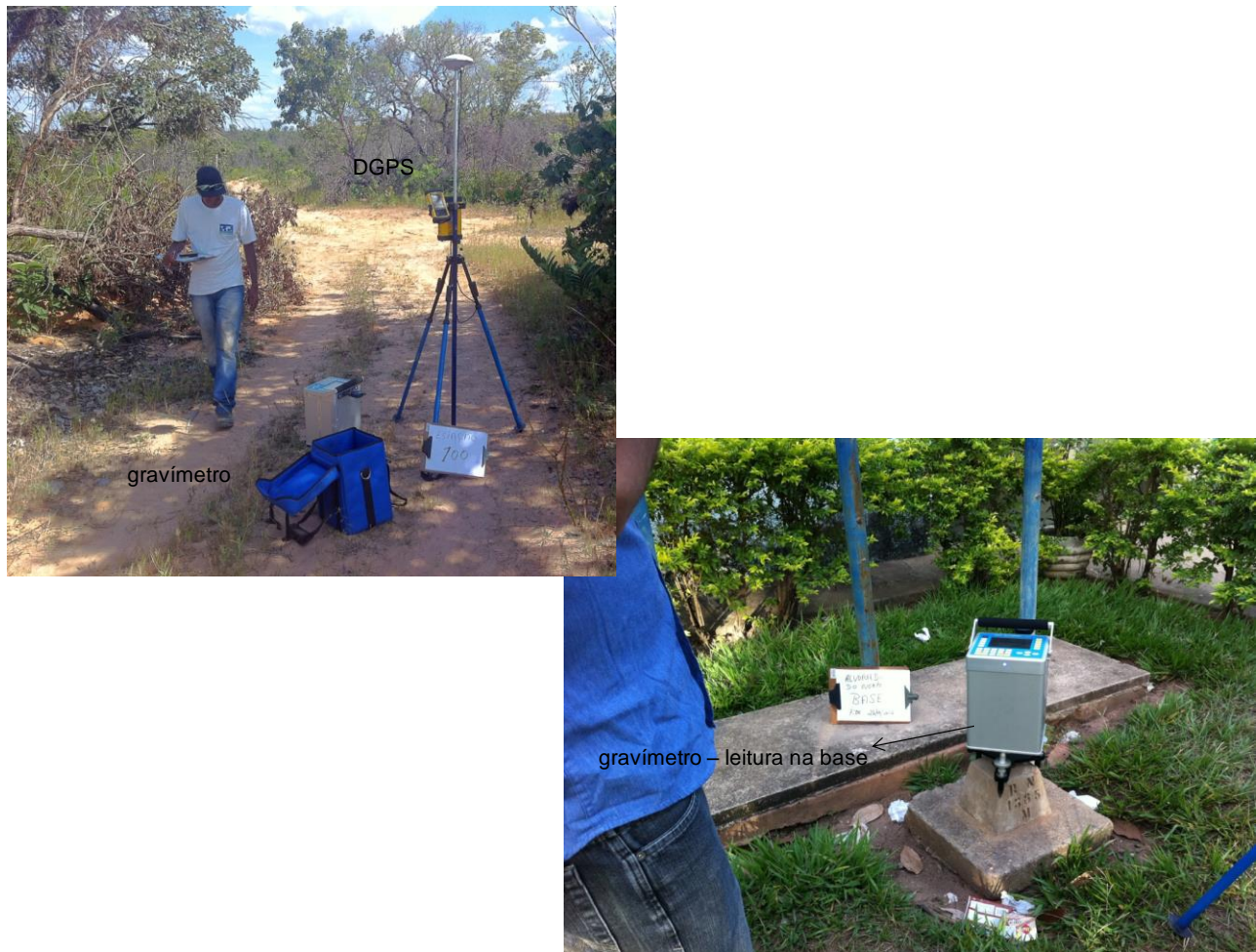
Figura 5.27 – Fotos ilustrando o levantamento geofísico por meio do método gravimétrico.
