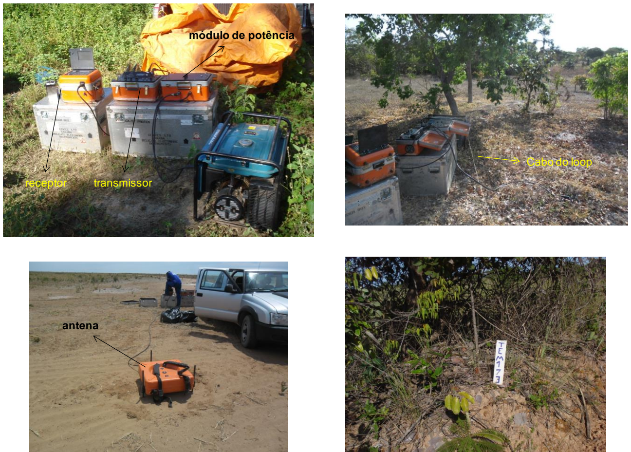
Figura 5.22 – Fotos ilustrando o levantamento geofísico por meio da técnica de sondagem TDEM.
