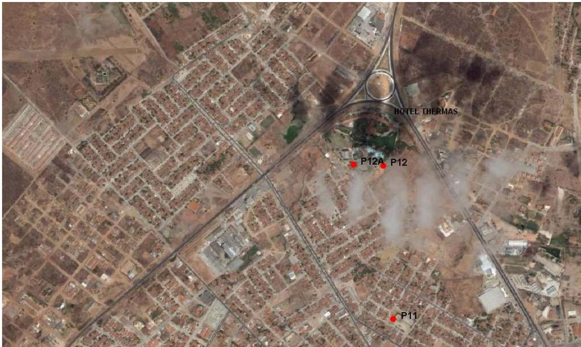
**Figura 4.52** – Localização do sítio de execução do teste do aquífero Açú em Mossoró usando os poços P12A e P12 do Hotel Thermas e incluindo (como superposição de escoamento) o efeito da paralisação de um terceiro poço (P11) localizado a cerca de 700 m ao sul.
