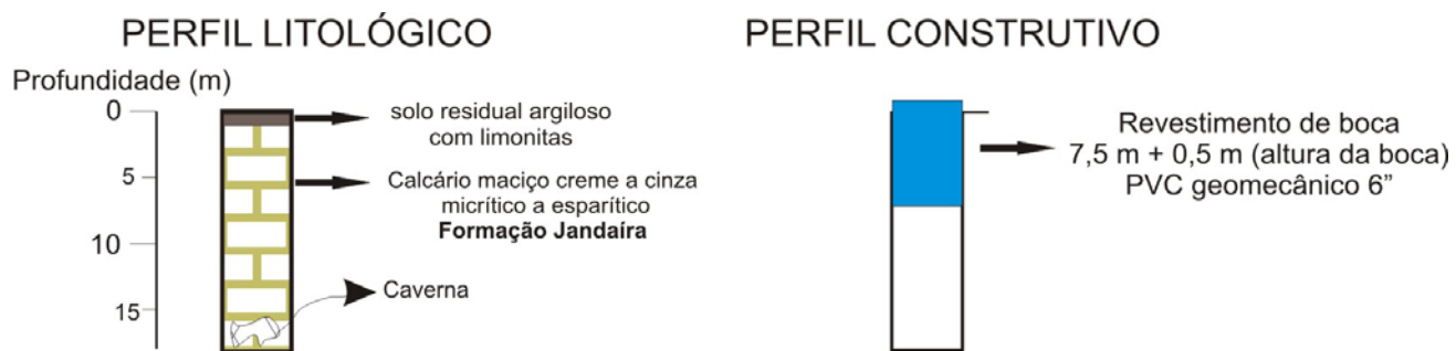
Figura A4.5.2c – Perfil litológico e construtivo do poço P1-SF – ANA 1436 – no aquífero Jandaíra em Sítio Formigueiro, município de Jaguaruana-CE.
