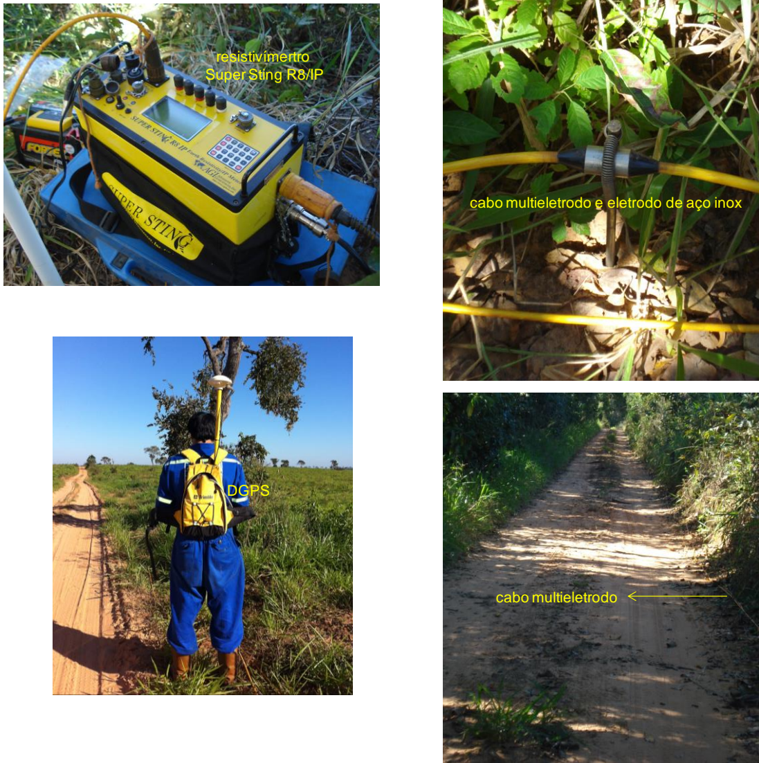
Figura 1.56 – Fotos ilustrando o levantamento geofísico por meio da técnica de imageamento elétrico 2D.
