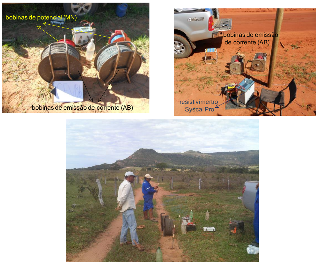
Figura 1.51 – Fotos ilustrando o levantamento geofísico por meio da técnica de Sondagem Elétrica Vertical.
