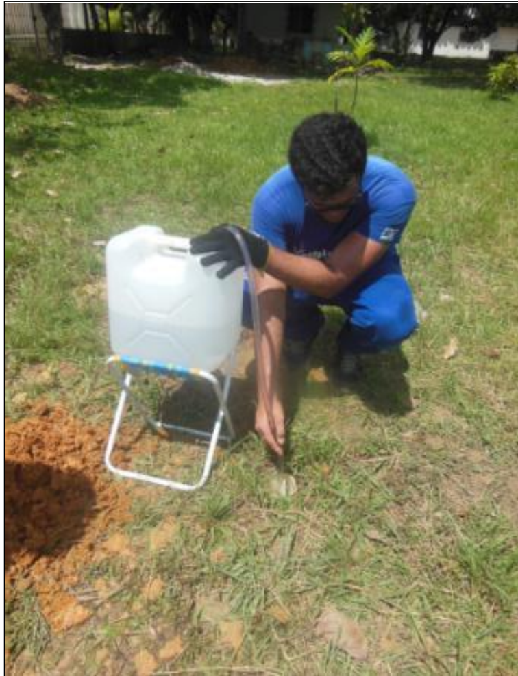
Figura 70 - Preenchimento do tubo cravado para o início do teste de infiltração.
