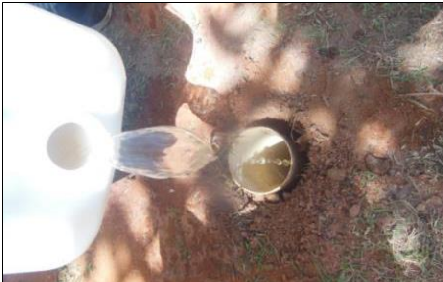
Figura 11 - Preenchimento de água no tubo para o início do teste.
