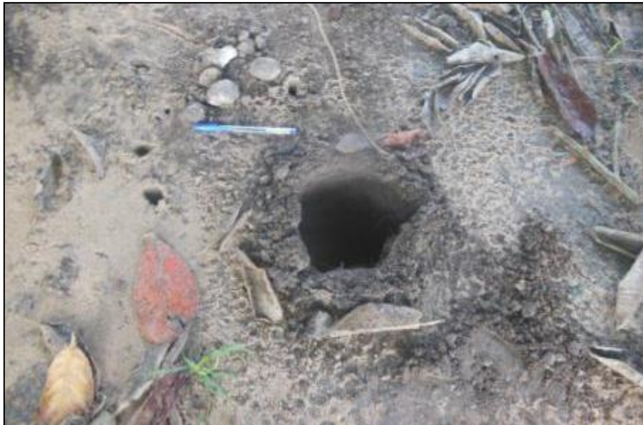
Figura 68 - Tentativa de realização dos furos para a realização dos testes de 1,0 m e 1,5 m que falharam, devido à presença de seixos de tamanhos diversos.
