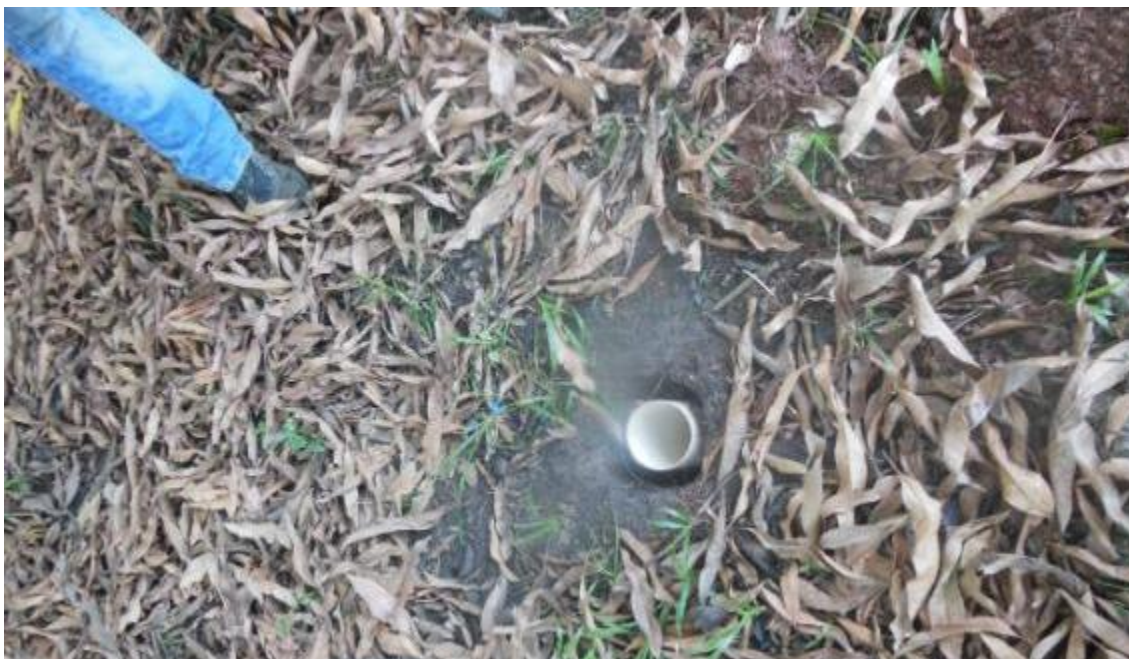
Figura 114 - Tubo no furo de 0,5m para o início do teste.
