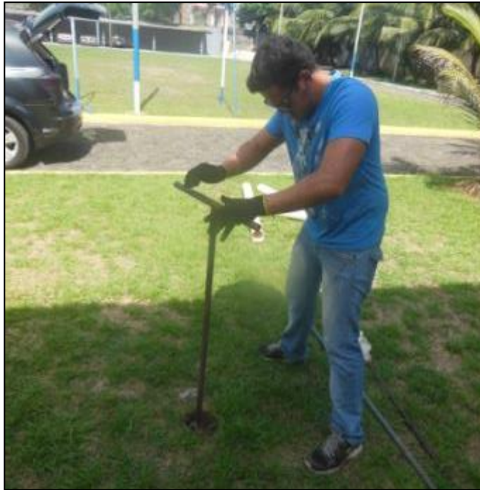
Figura 30 - Perfuração de 0,5 m para o teste de infiltração.
