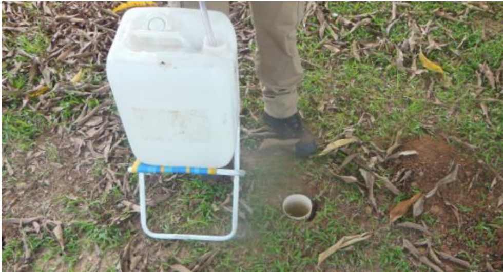
Figura 60 - Preenchimento de água no tubo de 0,5 m para a realização do teste de infiltração.
