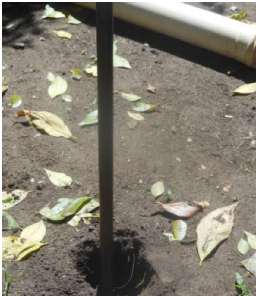
Figura 38 - Furo para o teste de infiltração na profundidade de 0,5 m.
