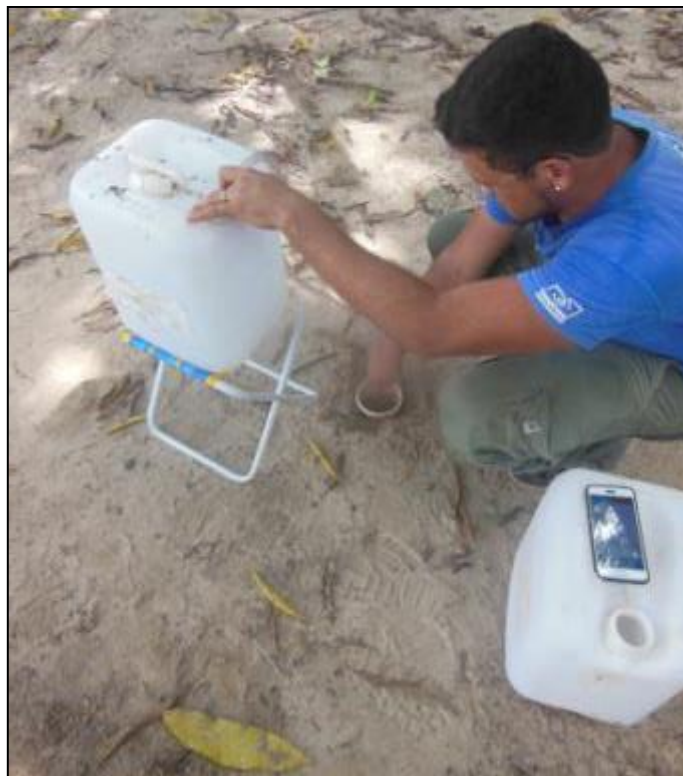
Figura 104 - Preenchimento de água no tubo para o início do teste de infiltração.
