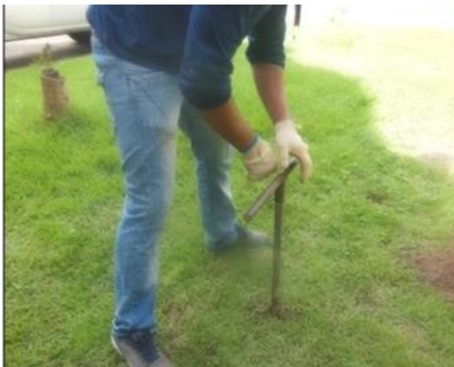
Figura 3 – Execução dos furos de trado para a realização dos testes de infiltração.
