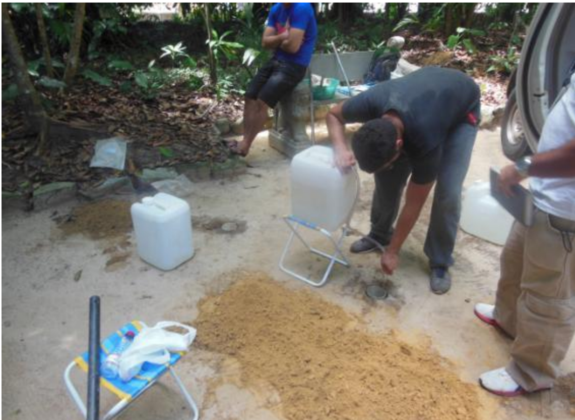
Figura 22 - Preenchimento de água no tubo para o início do teste de infiltração.
