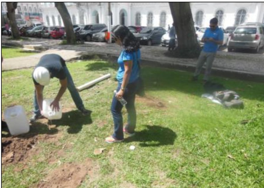
Figura 16 - Preenchimento de água no furo para o início do teste.
