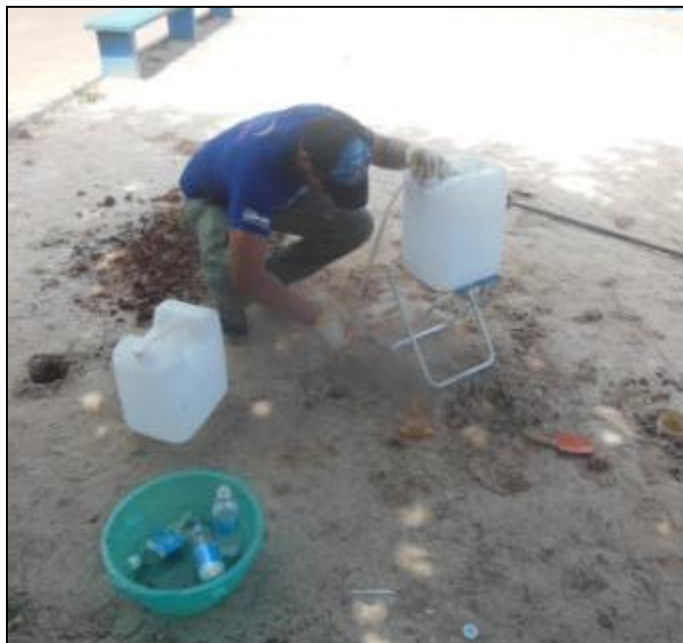
Figura 96 - Preenchimento de água no tubo cravado para o teste na profundidade de 1,0 m.
