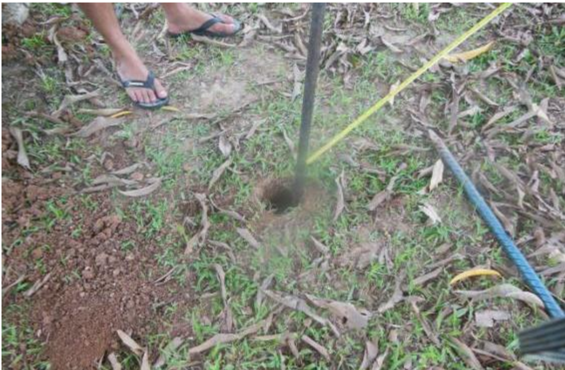
Figura 59 - Furo de 0,5 m perfurado para o teste de infiltração.
