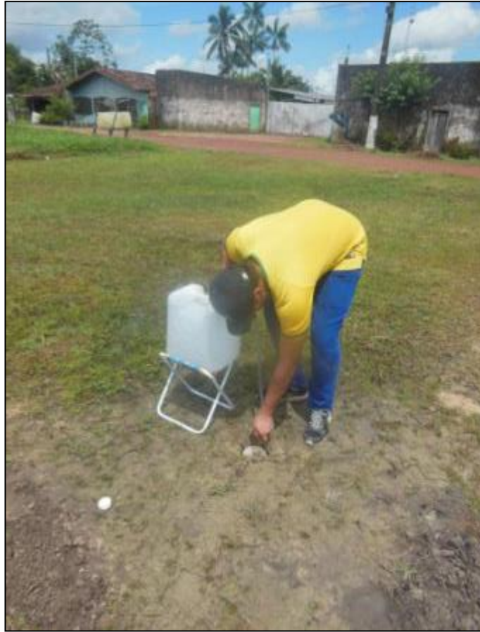
Figura 82 - Preenchimento do tubo cravado para o início do teste de infiltração.
