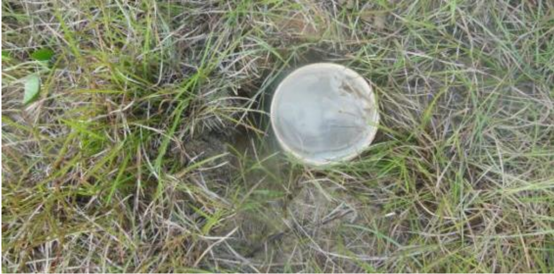
Figura 122 - Preenchimento de água no tubo para o início do teste.
