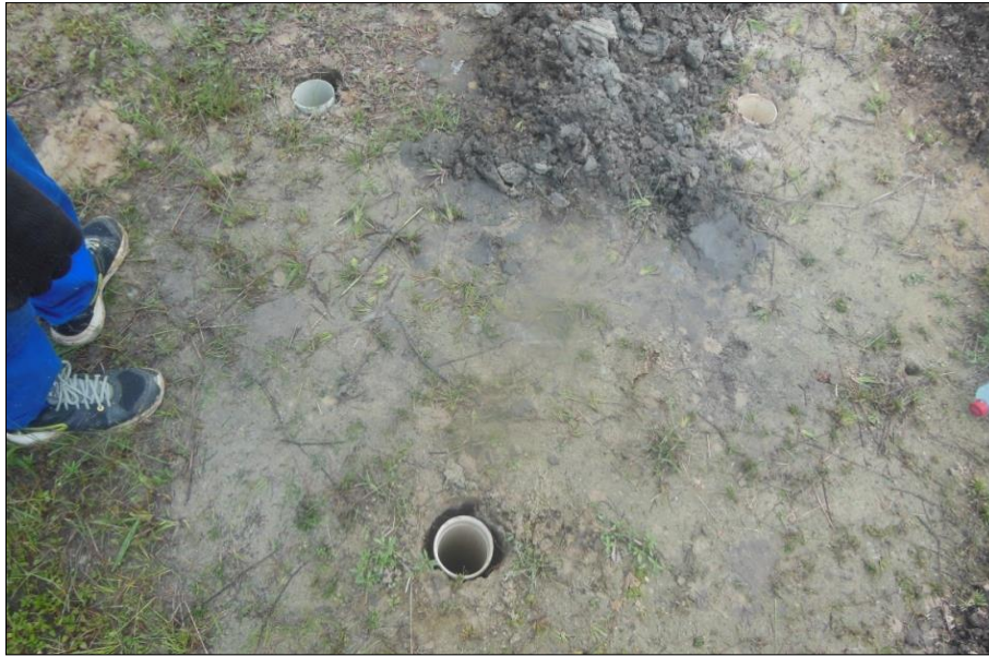
Figura 4 – Disposição dos furos com tubos cravados para realização do teste de infiltração.
