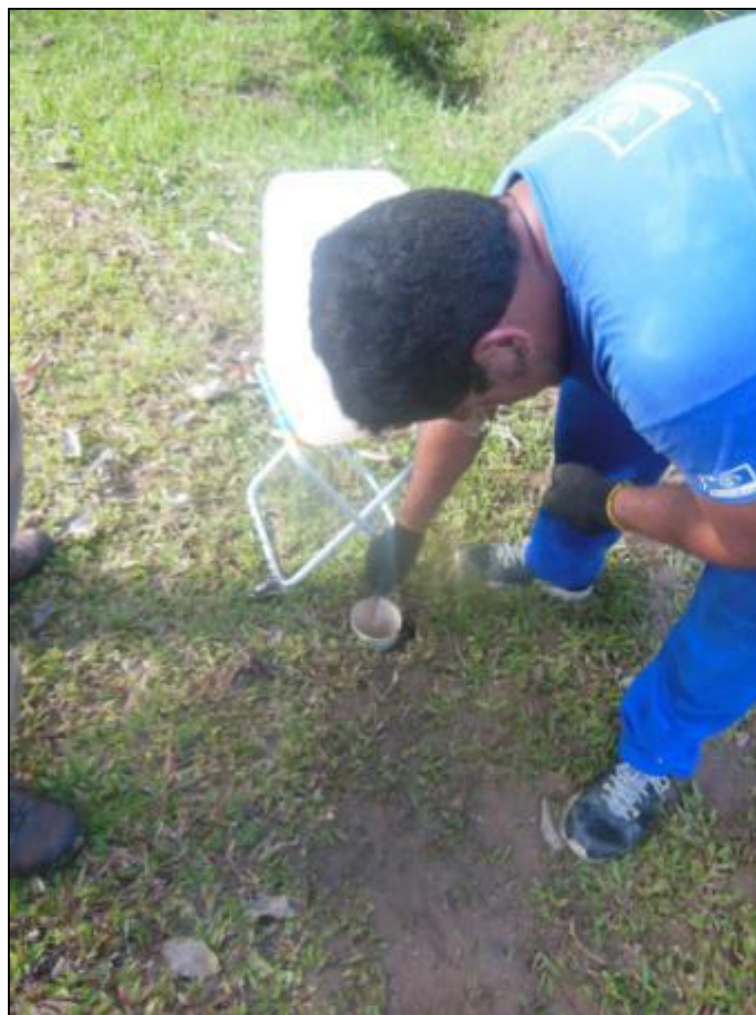
Figura 67 - Preenchimento do tubo para o início do teste de infiltração.
