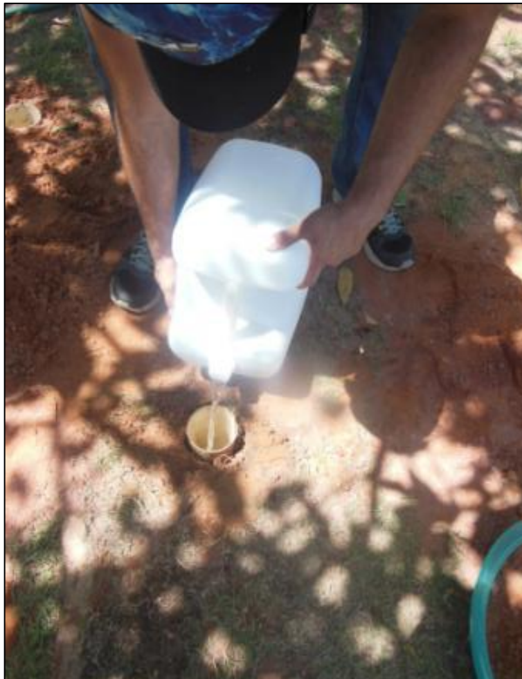
Figura 10 - Preenchimento de água no tubo para o início do teste.
