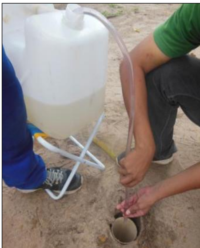
Figura 26 - Preenchimento de água no tubo para o início do teste de infiltração.
