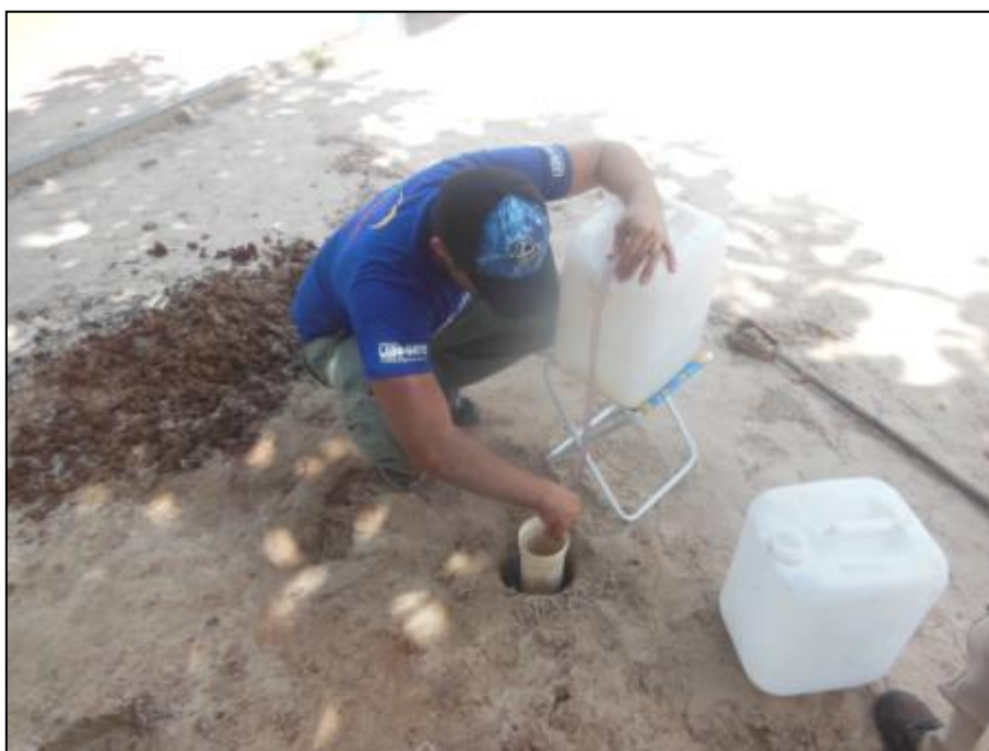
Figura 95 - Preenchimento de água no tubo cravado para o teste na profundidade de 1,5 m.
