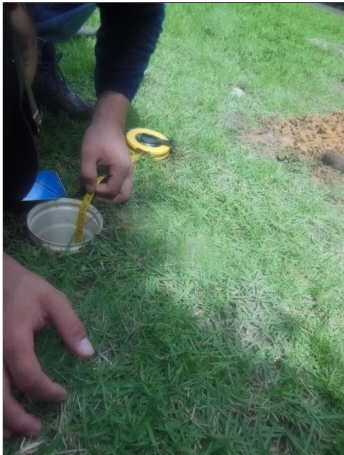
Figura 6 – Medição da variação do nível de água no tubo cravado.
