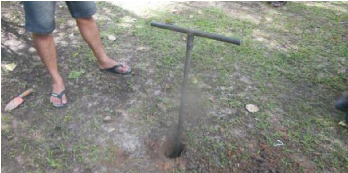
Figura 64 - Furo de 0,5 m perfurado para o teste de infiltração.
