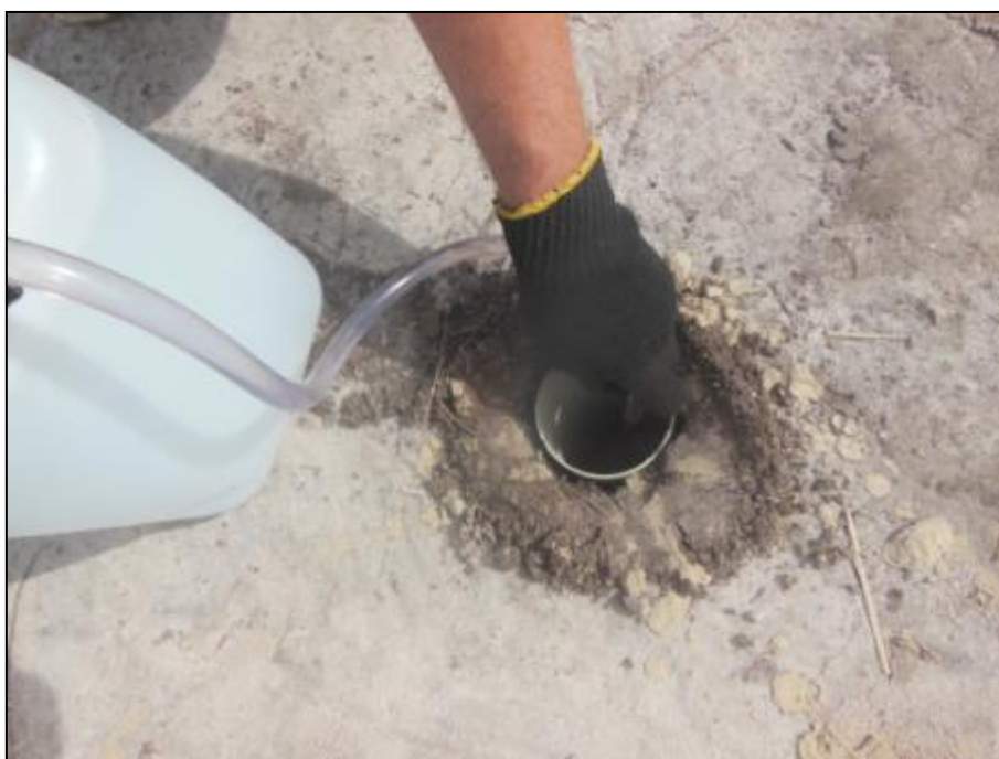
Figura 91 - Preenchimento de água no tubo de 0,5 m para a realização do teste de infiltração.
