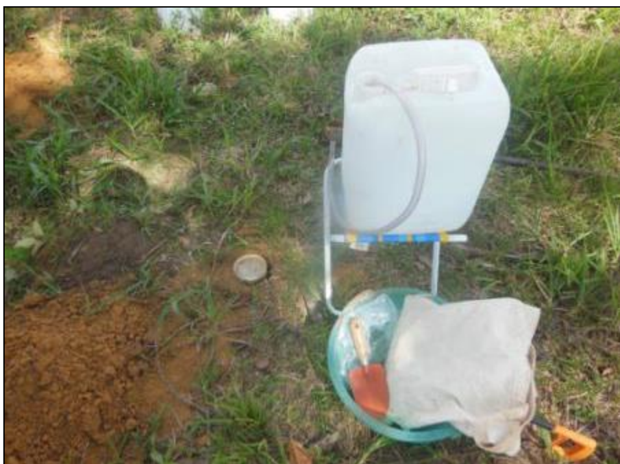
Figura 110 - Tubo cravado para o preenchido com água para o início do teste.
