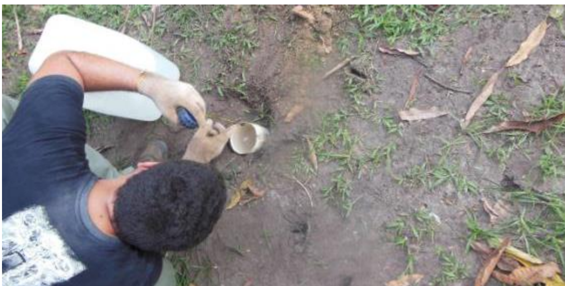
Figura 50 - Medição da variação do nível d'água no tubo.
