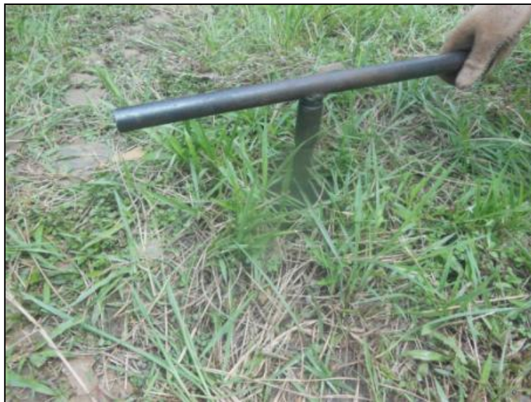
Figura 71 - Furo para o teste de infiltração na profundidade de 1,0 m.
