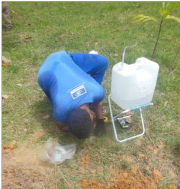
Figura 72 - Medição da variação do nível d'água no tubo.
