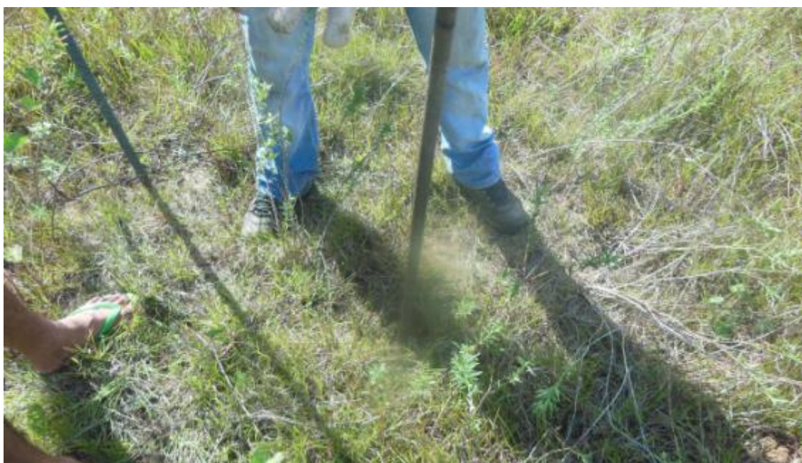
Figura 121 - Perfuração do furo de 1,0 m para o teste de infiltração.
