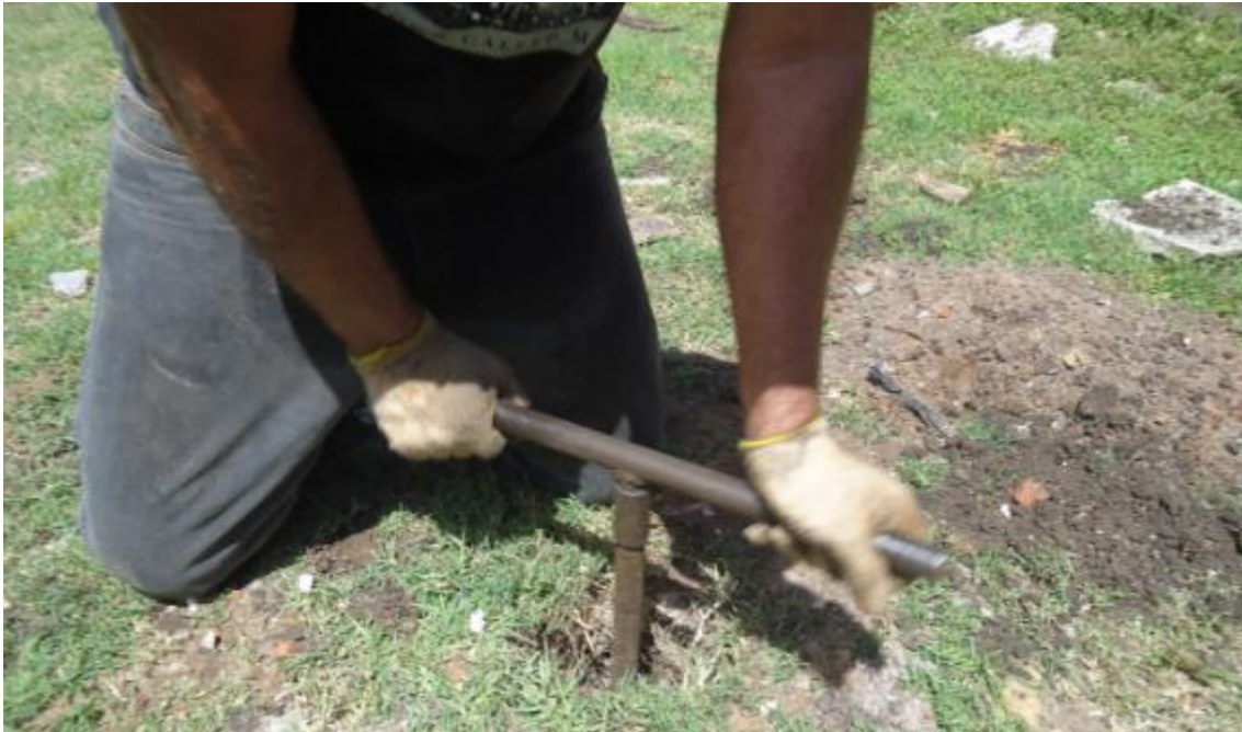
Figura 34 - Furo de 1,0 m perfurado para o teste de infiltração.
