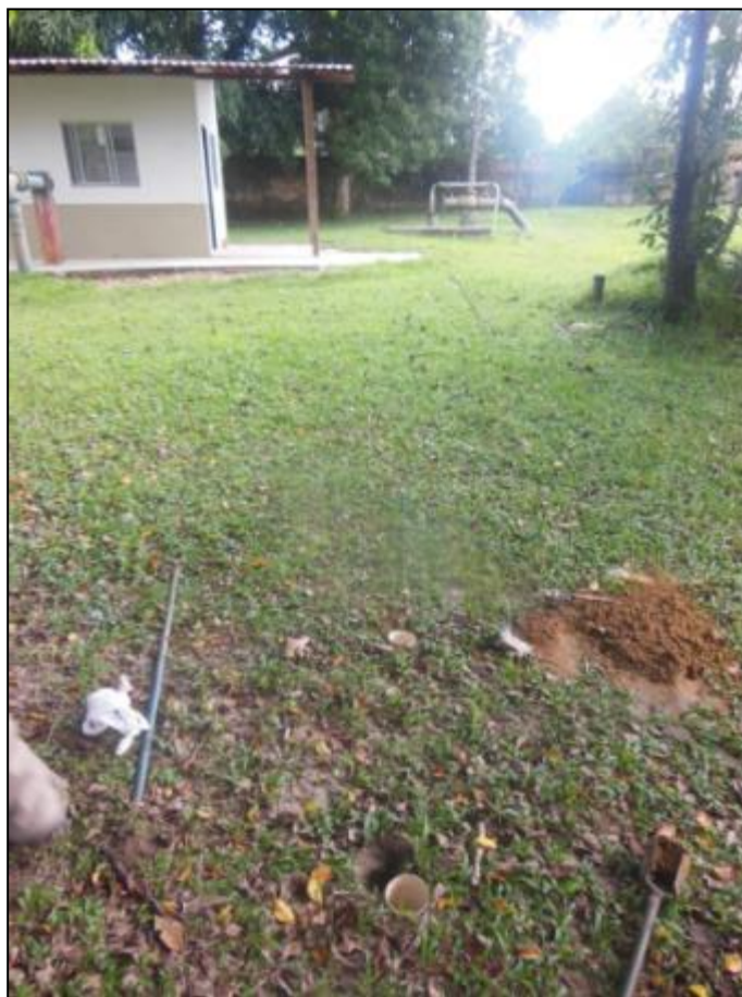
Figura 79 - Furos prontos para o início dos testes de infiltração.
