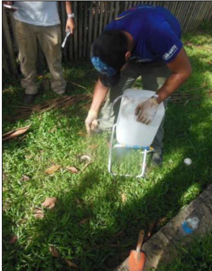
Figura 100 - Preenchimento de água do tubo cravado para o início do teste de infiltração.
