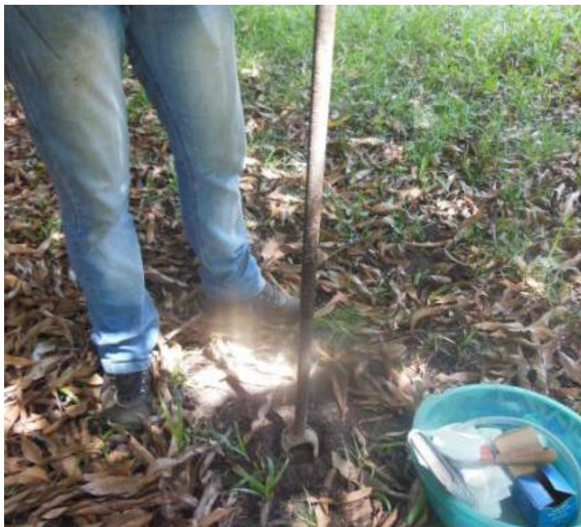
Figura 113 - Perfuração do furo de 0,5 m para o teste de infiltração.
