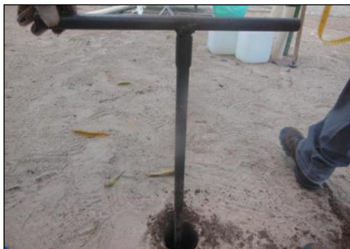
Figura 25 - Perfuração do furo de 0,5 m para a realização do teste de infiltração.
