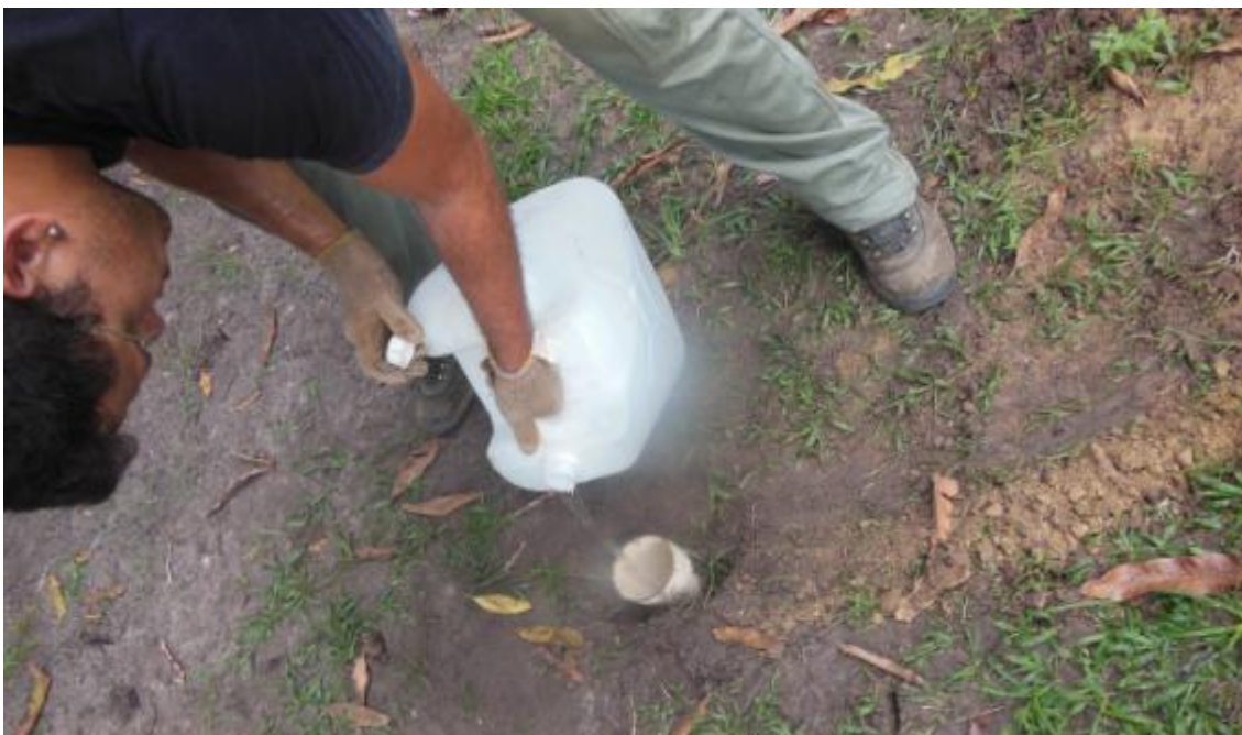
Figura 49 - Preenchimento do tubo cravado para o início do teste de infiltração.
