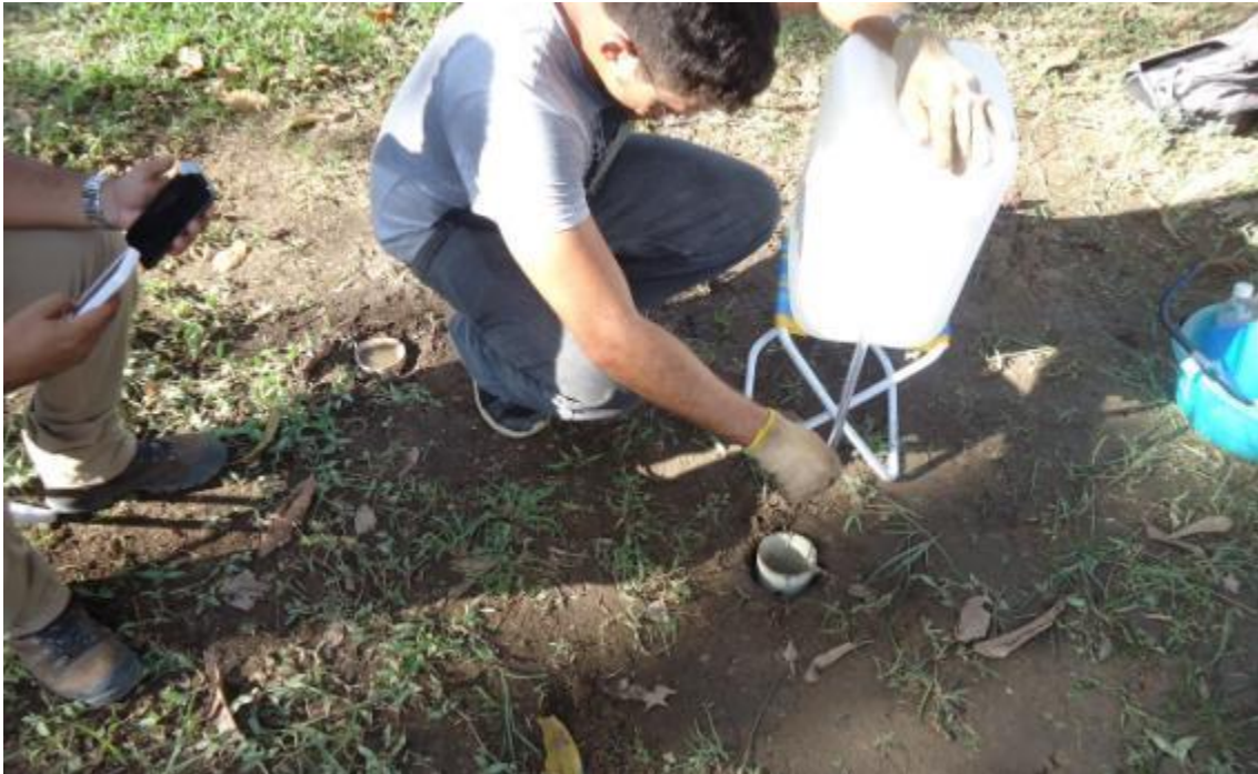
Figura 55 - Preenchimento de água no tubo de 1,0m para a realização do teste de infiltração.
