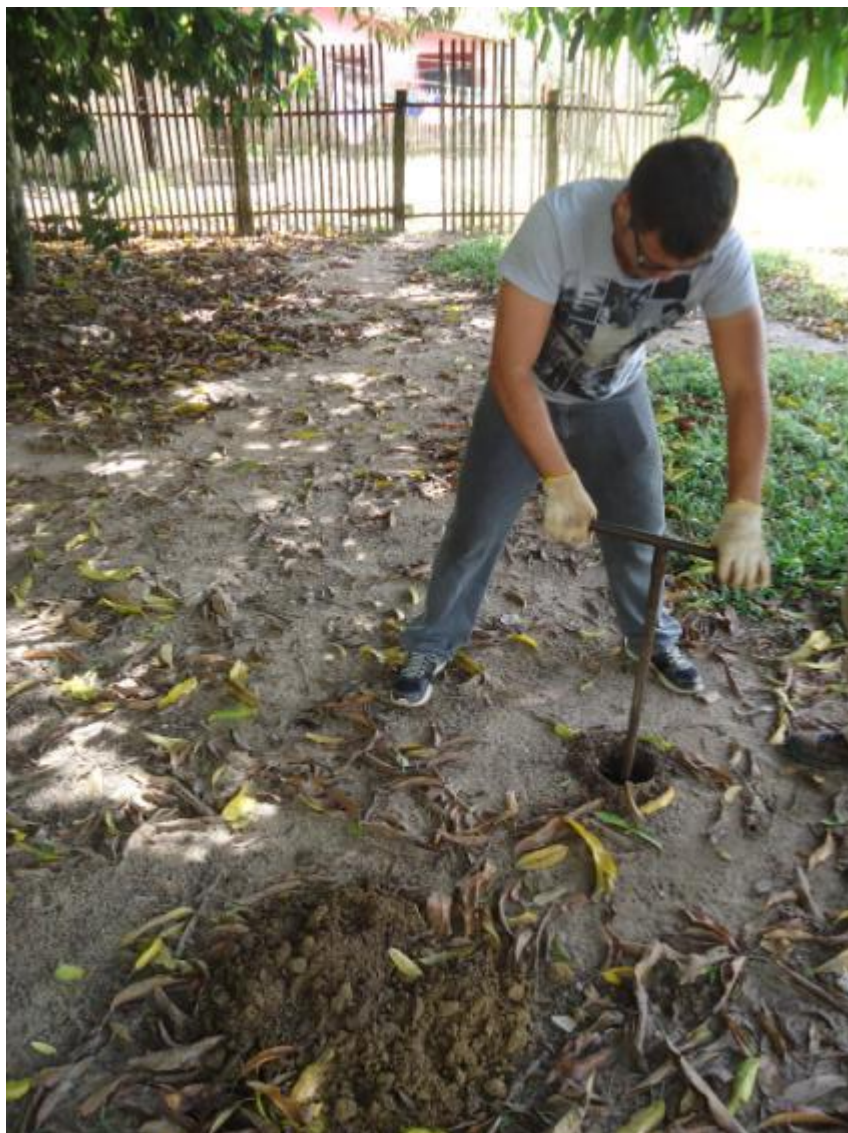
Figura 106 - Perfuração do furo de 0,5 m para o teste de infiltração.
