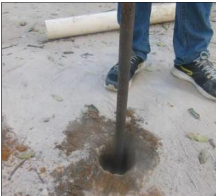
Figura 18 - Furo de trado para teste na profundidade de 0,5m.
