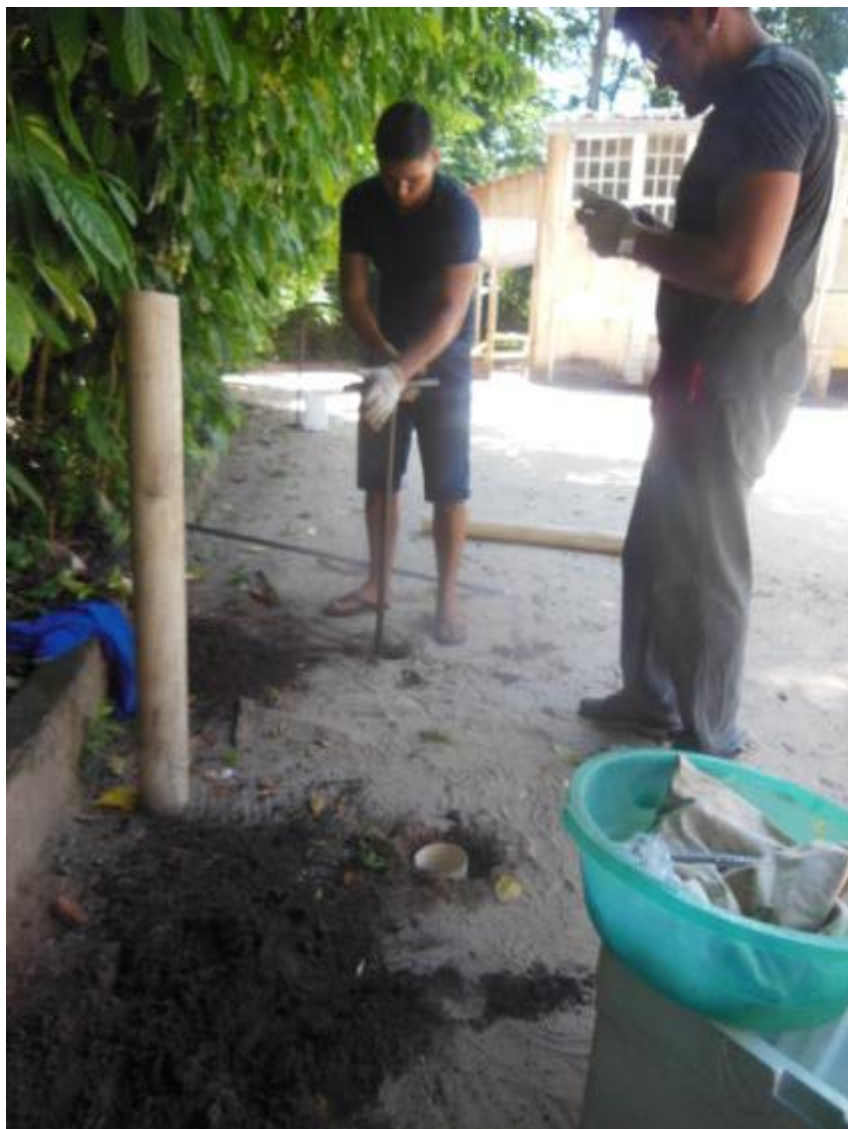
Figura 42 - Furo para o teste de infiltração na profundidade de 1,0 m.
