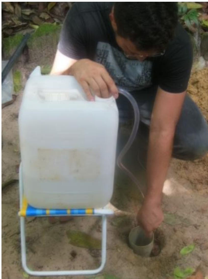
Figura 45 - Preenchimento de água para teste no furo no 0,5m.
