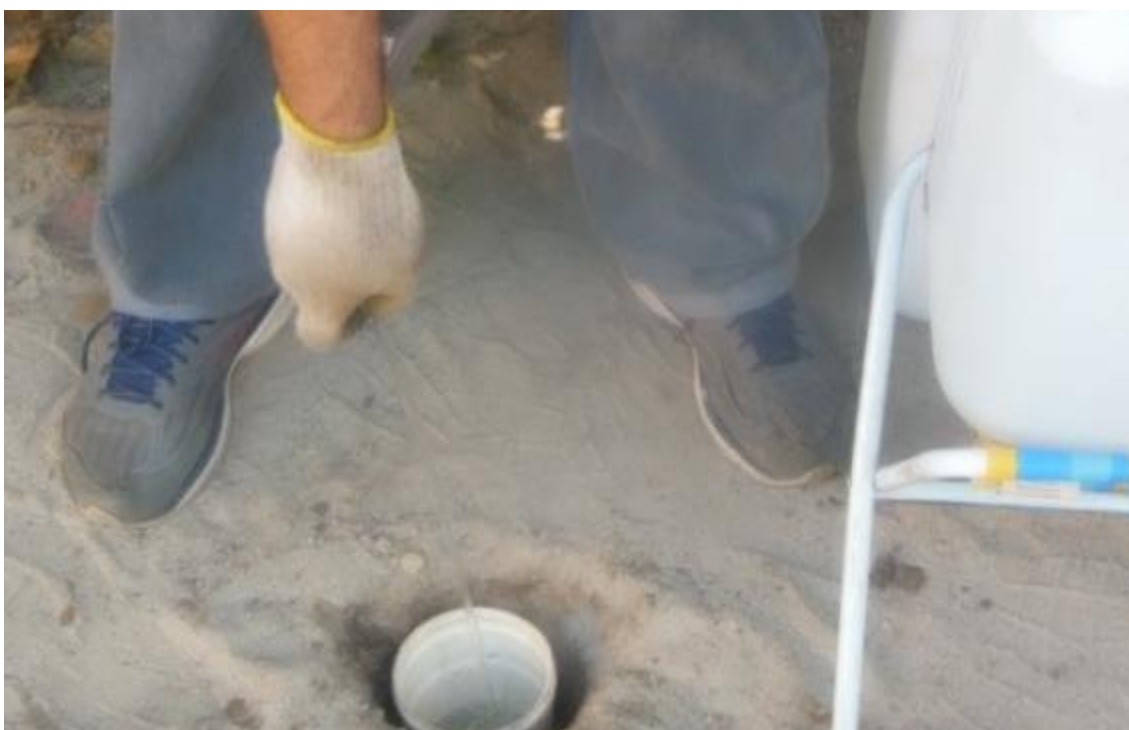
Figura 41 - Preenchimento do tubo cravado para o início do teste de infiltração.
