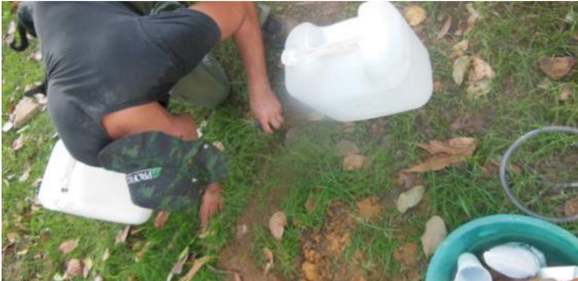
Figura 76 - Preenchimento de água no tubo de 0,5m para a realização do teste de infiltração.
