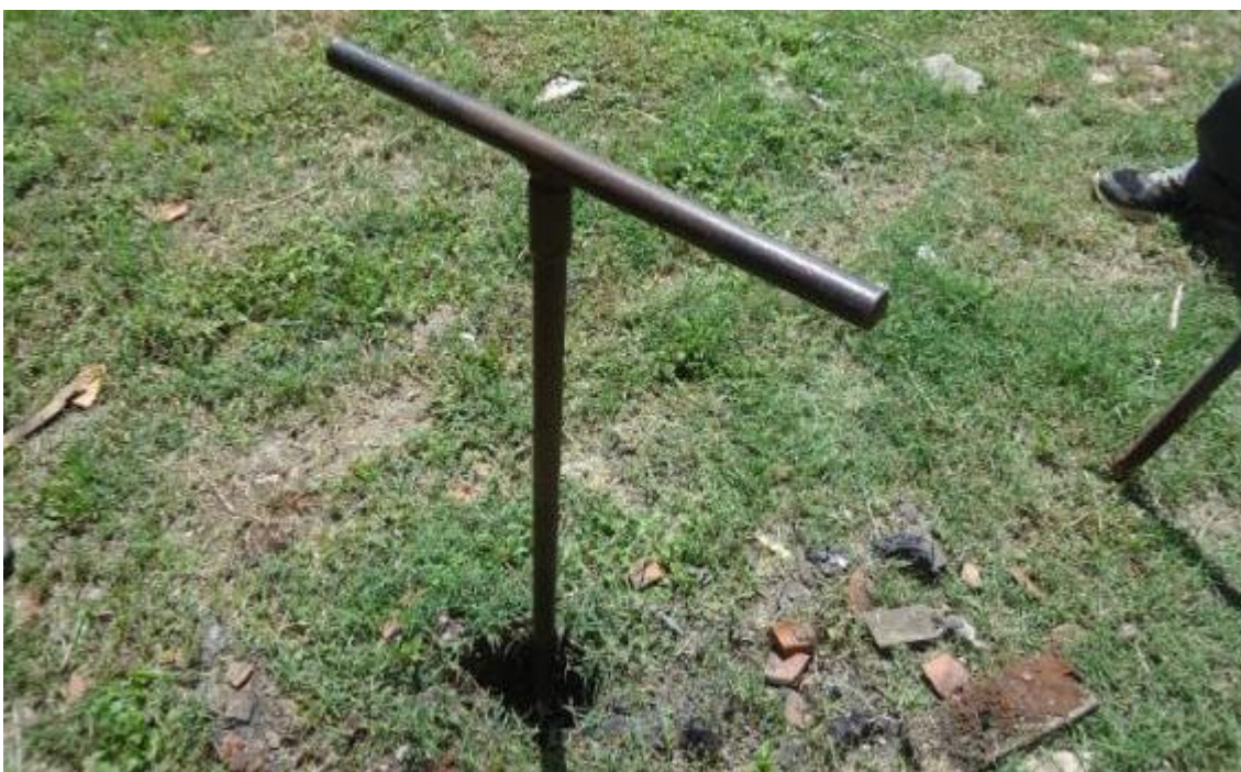
Figura 33 - Furo de 0,5 m perfurado para o teste de infiltração.
