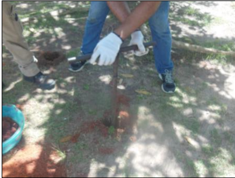
Figura 9 - Perfuração do furo de 1,0 m para o teste de infiltração.
