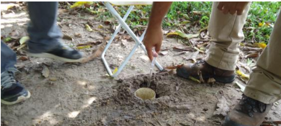
Figura 108 - Preenchimento de água no tubo para o início do teste de infiltração.
