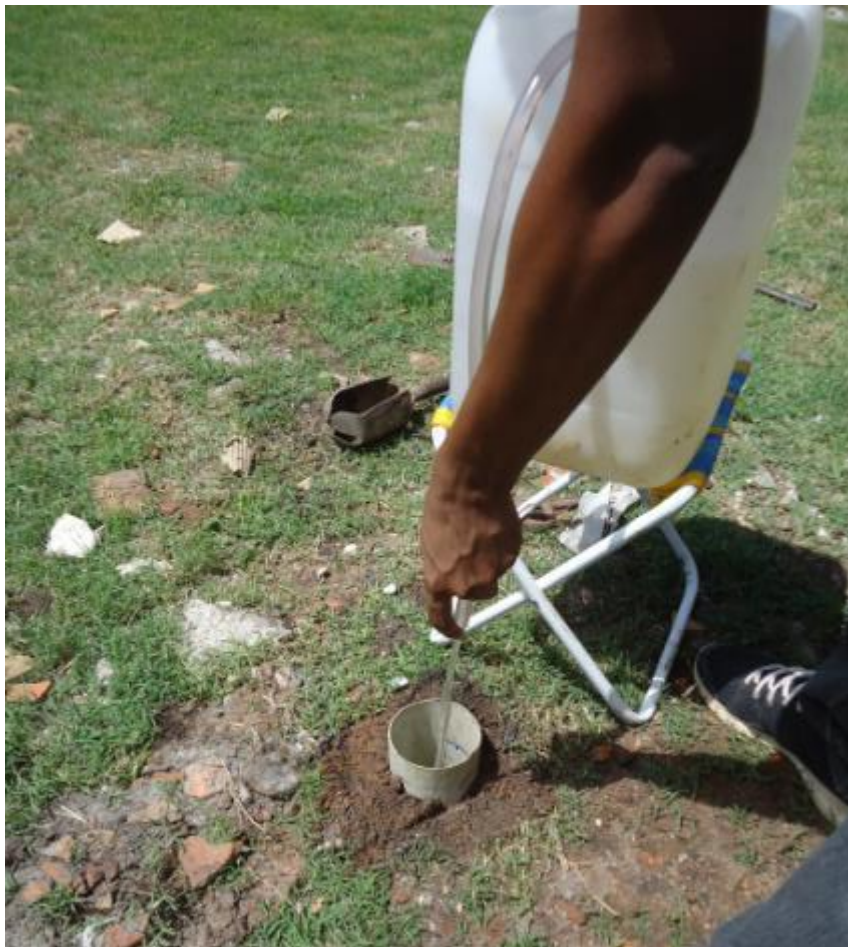
Figura 35 - Preenchimento de água no tubo de 0,5 m para a realização do teste de infiltração.
