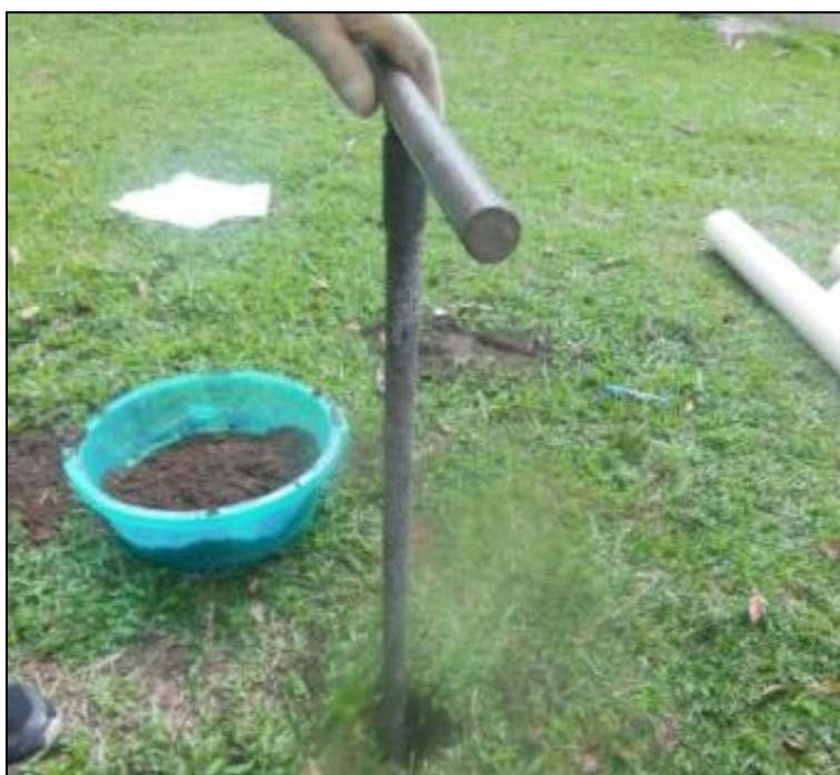
Figura 14 - Furo para o teste na profundidade de 0,5m.
