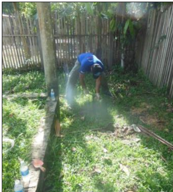
Figura 98 - Execução dos furos de trado para o início dos testes de infiltração.
