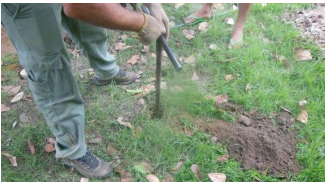
Figura 75 - Furo de 1,0 m perfurado para o teste de infiltração.
