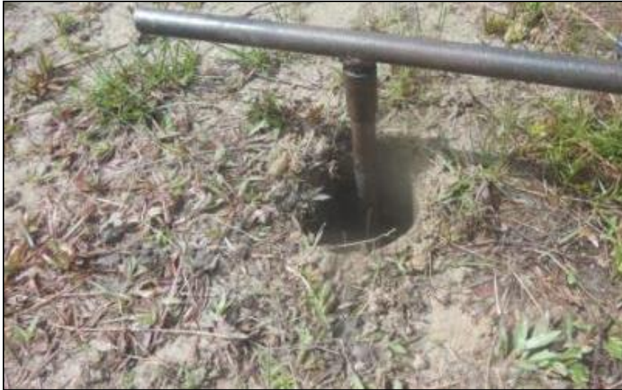
Figura 84 - Furo para a execução do teste de 1,0 m de profundidade.
