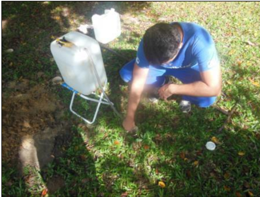
Figura 78 - Preenchimento do tubo cravado para o início do teste de infiltração.
