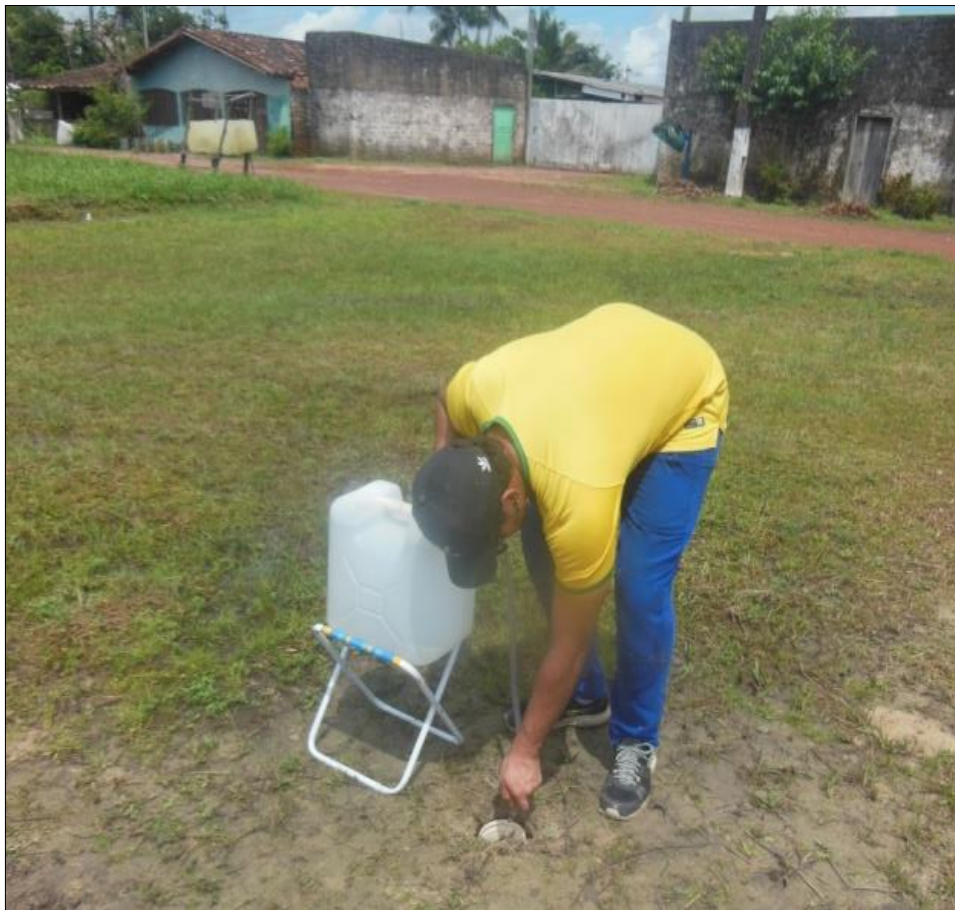
Figura 5 – Preenchimento de água no tubo para o início do teste de infiltração.
