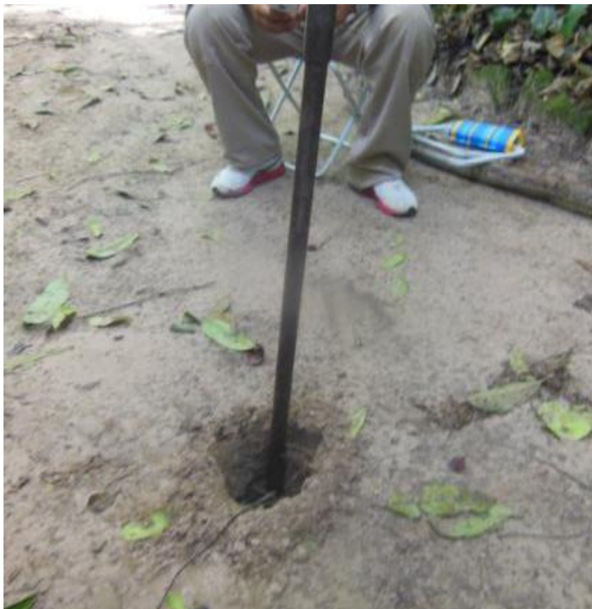
Figura 44 - Furo de 0,5m perfurado para o teste de infiltração.
