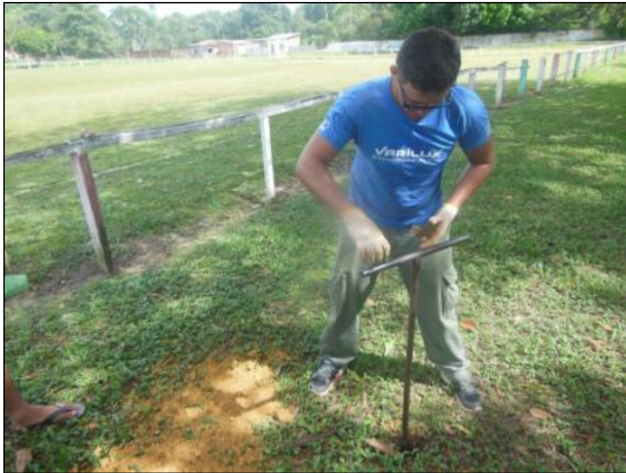
Figura 128 - Perfuração do furo de 1,0 m para o teste de infiltração.
