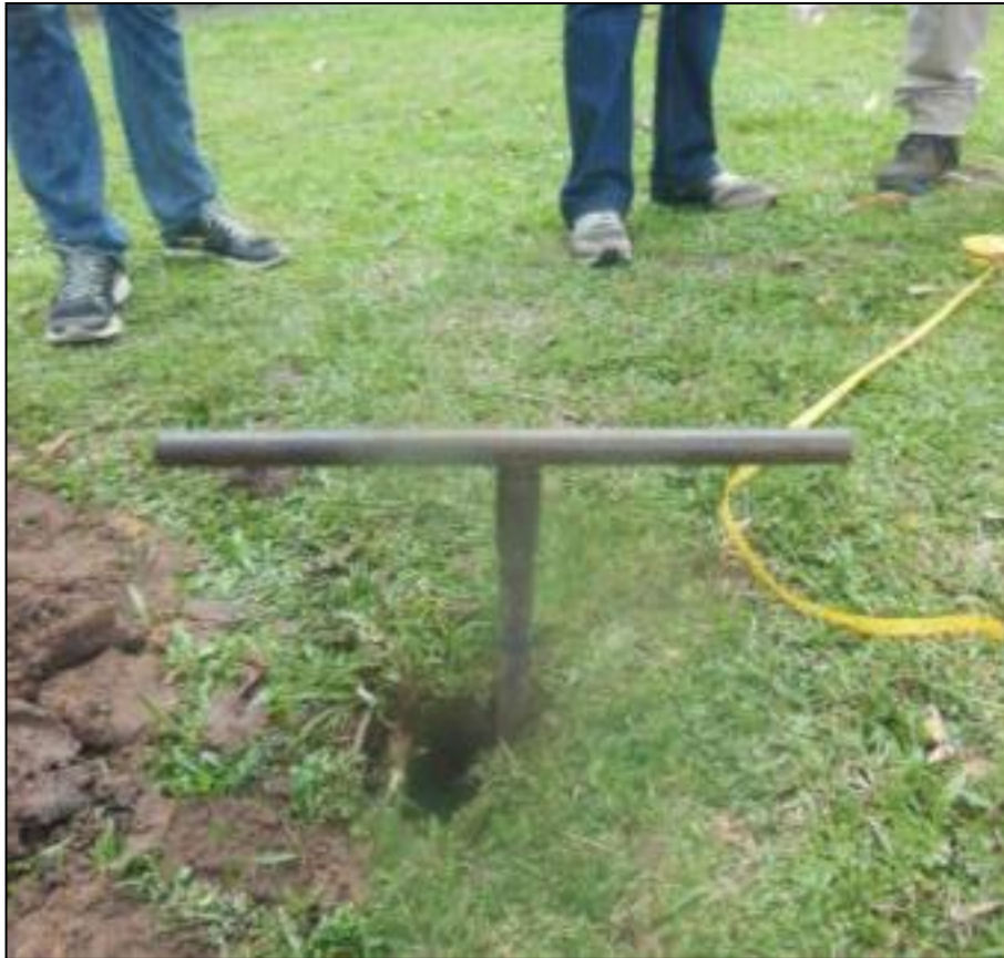
Figura 15 - Furo para teste na profundidade de 1,0 m.
