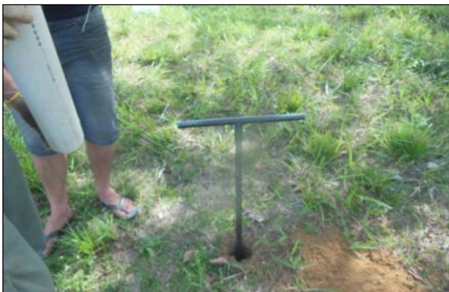
Figura 112 - Perfuração do furo de 0,5 m para o teste de infiltração.
