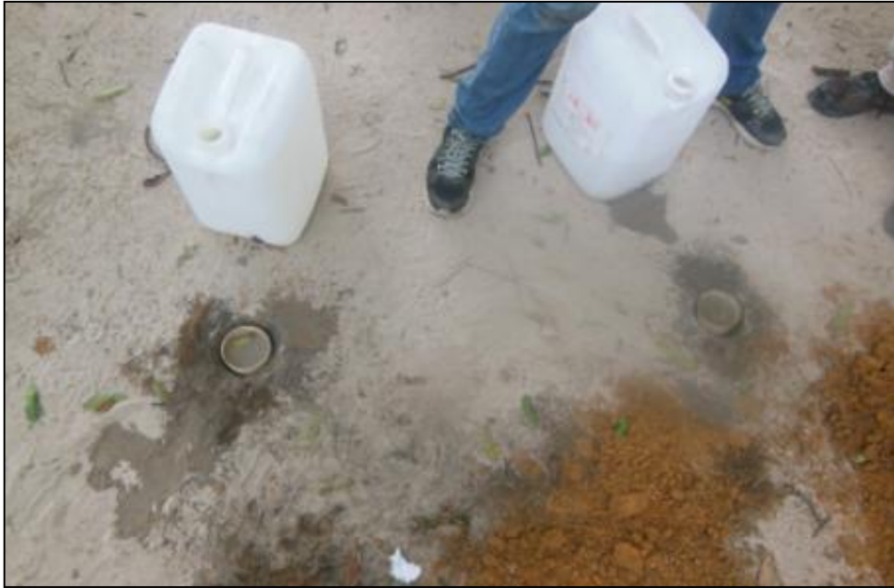
Figura 19 - Execução dos testes de infiltração mostrando os tubos preenchidos com água.
