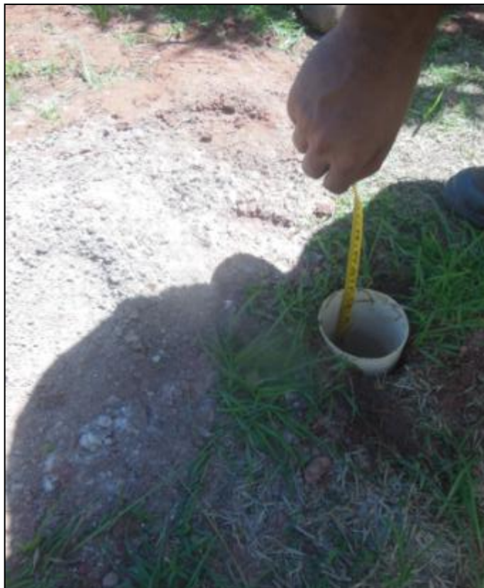
Figura 31 - Medição do nível de água durante a realização do teste de infiltração.
