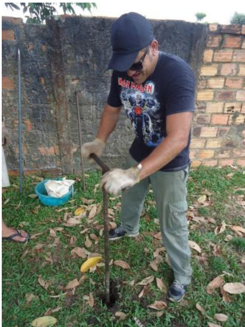
Figura 57 - Início da execução do Furo de 0,5m perfurado para o teste de infiltração.
