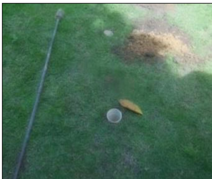
Figura 73 - Furos executados nas profundidades de 0,5 m, 1,0 m e 1,5 m para o teste de infiltração.
