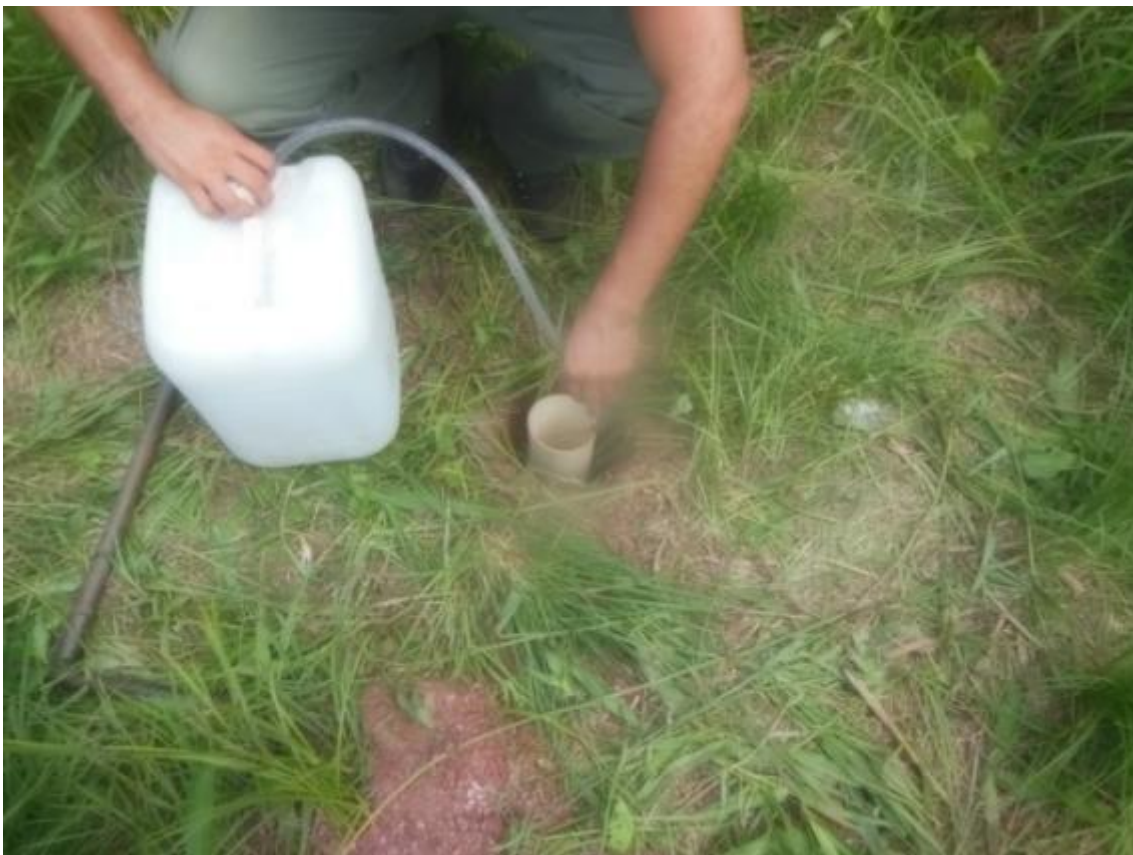
Figura 125 - Preenchimento do tubo para o início do teste de infiltração.
