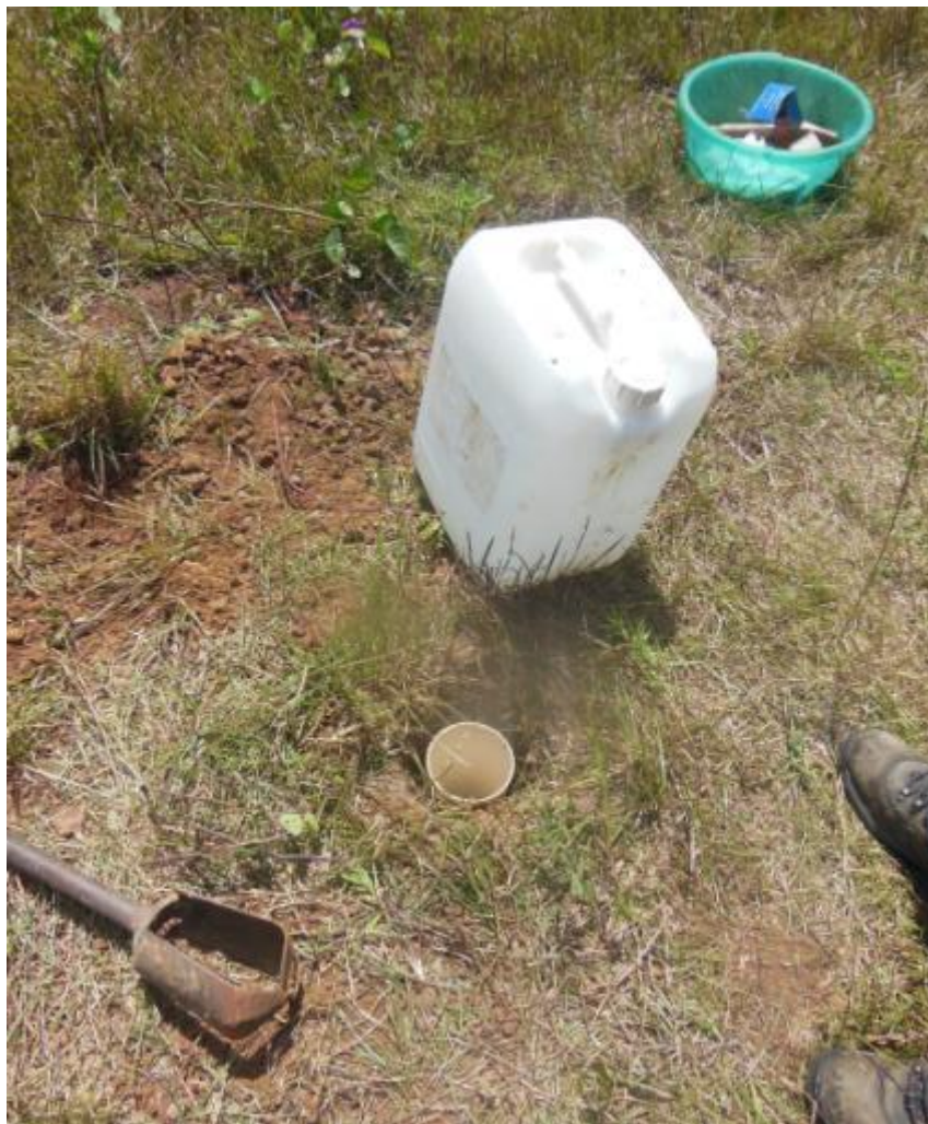
Figura 116 - Preenchimento do tubo para o início do teste de infiltração.
