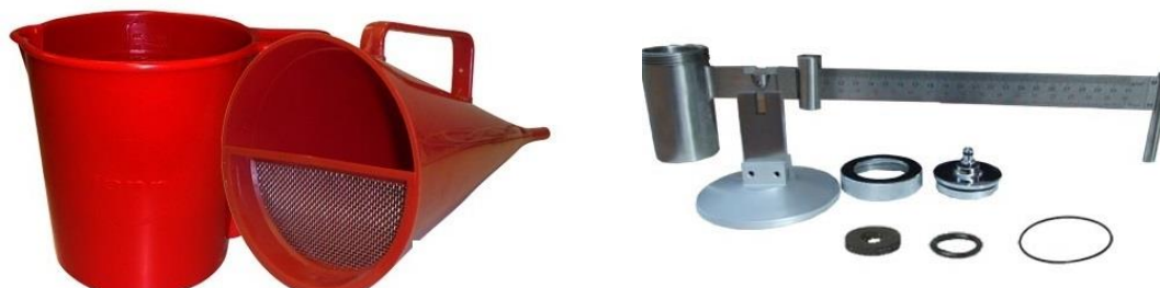
Figura 8 – Funil Marsh e balança de peso.
