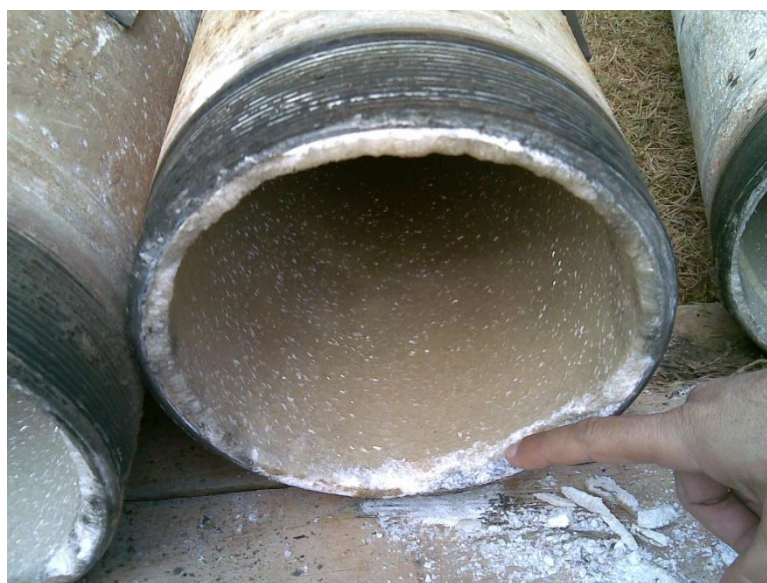
Figura 19 –Incrustações de carbonato de cálcio.
