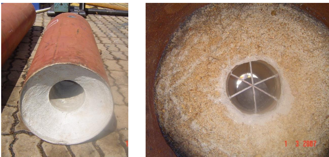
Figura 6 – Exemplo de sapata de cimentação.
