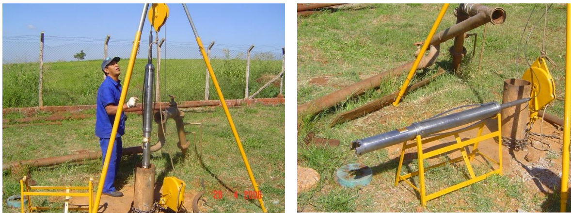
Figura 15 – Endoscopia ótica (filmagem) de poço.
