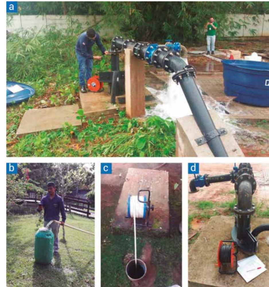
Testes de aquífero realizados. (a) poço bombeado, em Belém; (b) medição de vazão durante o teste, em Cotijuba; (c) poço de observação, em Benevides; e (d) poço de observação, em Belém (PA).
