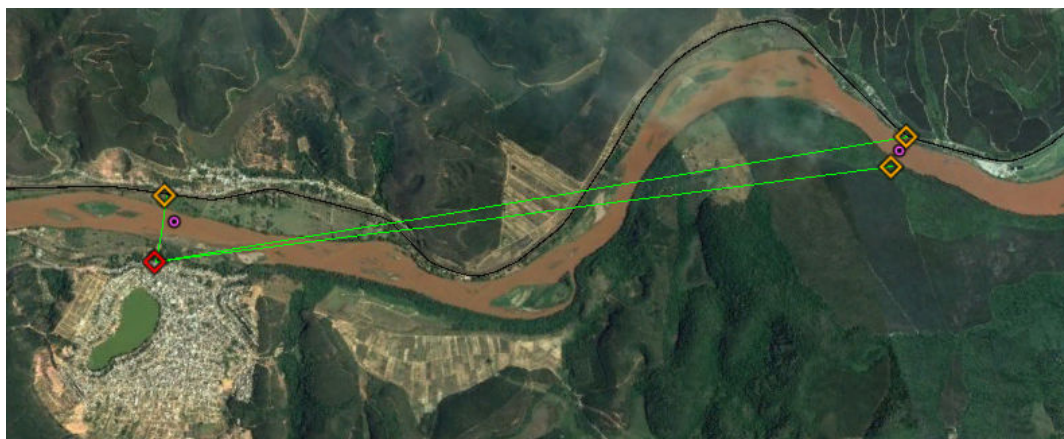
Figura 3 – Transporte de coordenadas a partir dos Marcos de Apoio Topográfico Planialtimétrico
