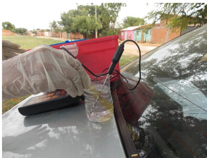
Figura 7.4 - Inserção do eletrodo para leitura dos parâmetros in situ .
