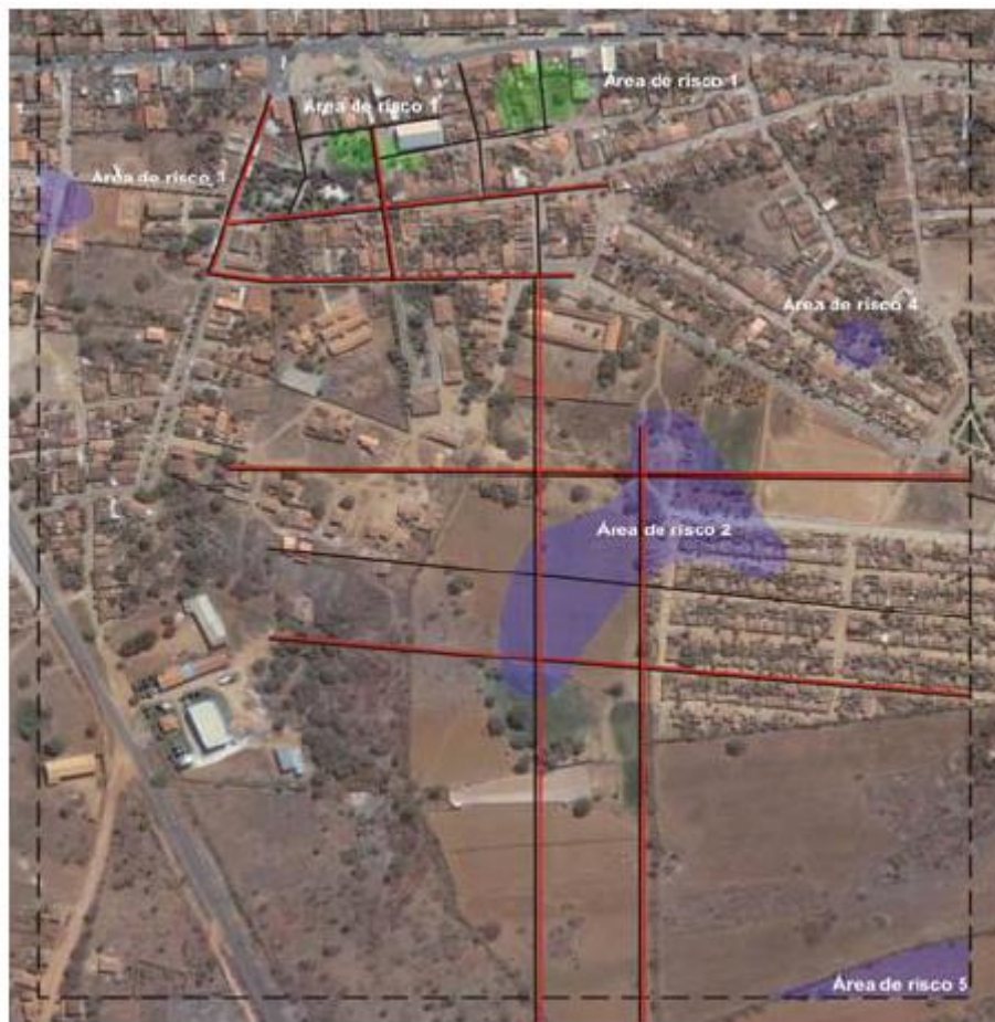
Figura 11.5: Posicionamento das áreas de risco na área urbana e periurbana de Lapão: em vermelho, eletrorresistividade + gravimetria e em preto, gravimetria. Fonte: Santos et al (2009)
