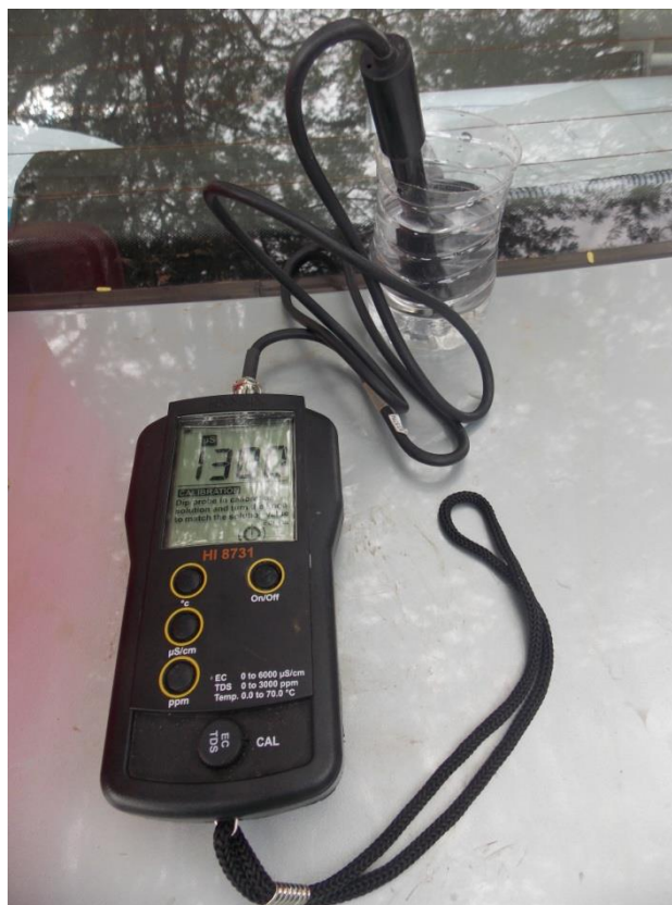
Figura 7.3 - Leitura dos parâmetros condutividade elétrica e sólidos totais dissolvidos.
