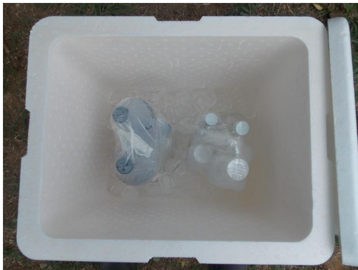
Figura 7.6 – Caixa térmica com gelo para acondicionamento e envio das amostras para o laboratório.
