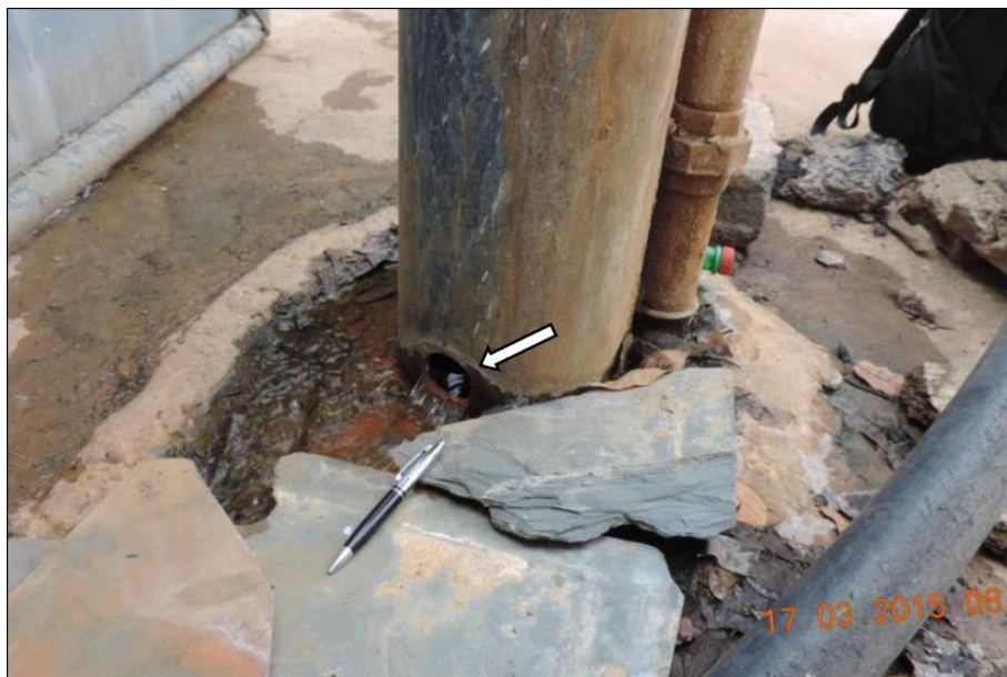
Figura 6.18 – Água do poço CO27 jorrando espontaneamente ao nível do solo no local indicado pela seta.
