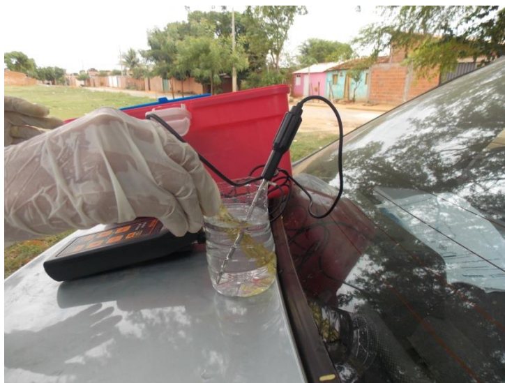
Figura 7.4 - Inserção do eletrodo para leitura dos parâmetros in situ.
