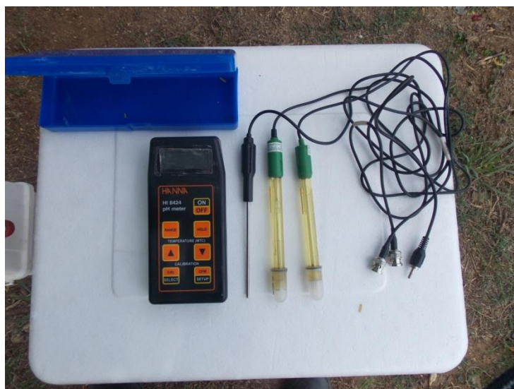
Figura 7.2 - Sonda e eletrodos para determinação da temperatura, pH e ORP.
