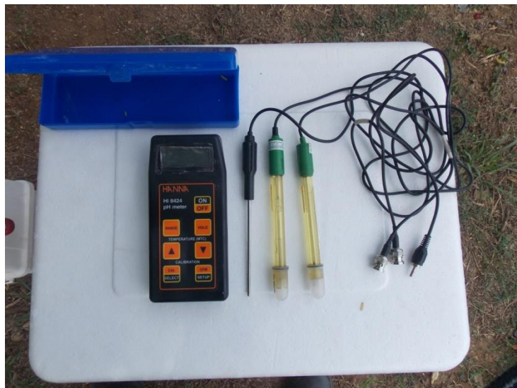
Figura 4.6 - Sonda e eletrodos para determinação da temperatura, pH e ORP.
