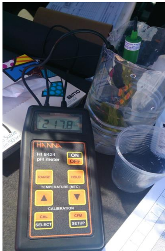
Figura 3.6 – Utilização de sonda para medição do ORP da água.
