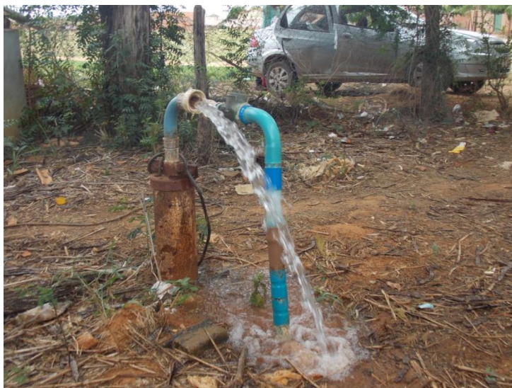
Figura 4.4 - Bombeamento do poço C-128 (Jaíba/MG) antecedendo a coleta para determinação dos parâmetros físico-químicos, agroquímicos, BTEX, fenóis e metais.
