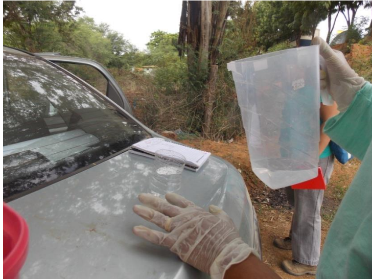
Figura 4.7 - Enchimento do frasco para determinação dos parâmetros in situ.
