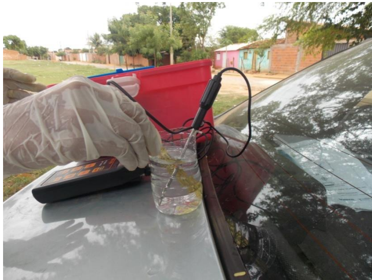
Figura 4.8 - Inserção do eletrodo para leitura dos parâmetros in situ.
