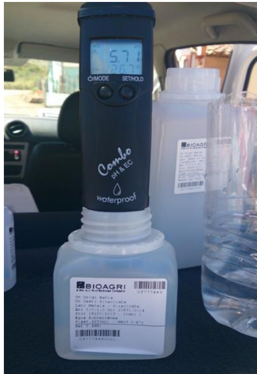
Figura 3.5 – Utilização de sonda para medição do pH da água.
