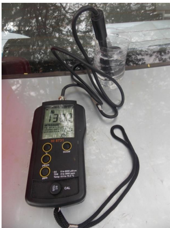
Figura 4.10 - Leitura dos parâmetros condutividade elétrica e sólidos totais dissolvidos.
