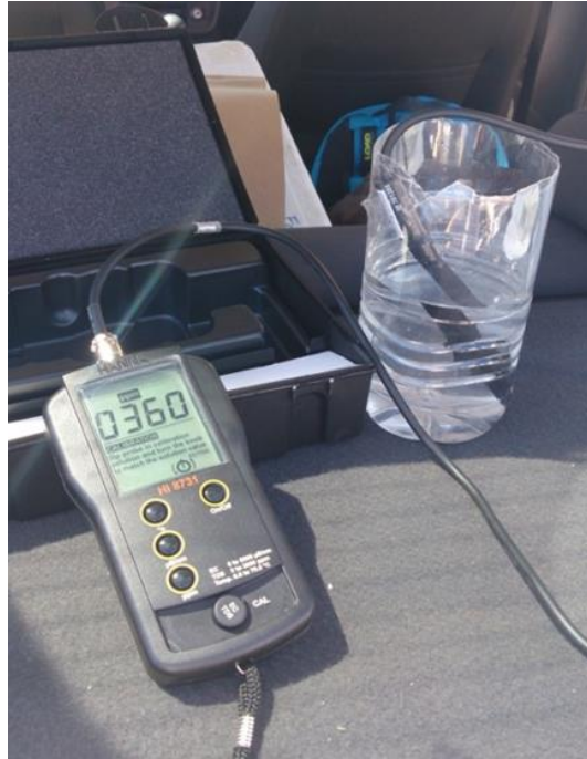
Figura 3.7 – Utilização de sonda para medição do ORP da água.
