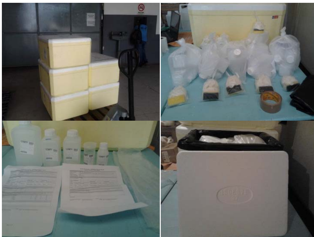
Foto 5.1 – Kit's de coletas usados em campo para as amostragens de água do aquífero Coberturas Cenozoicas de Porto Velho, nas duas campanhas, na cidade de Porto Velho - RO.
