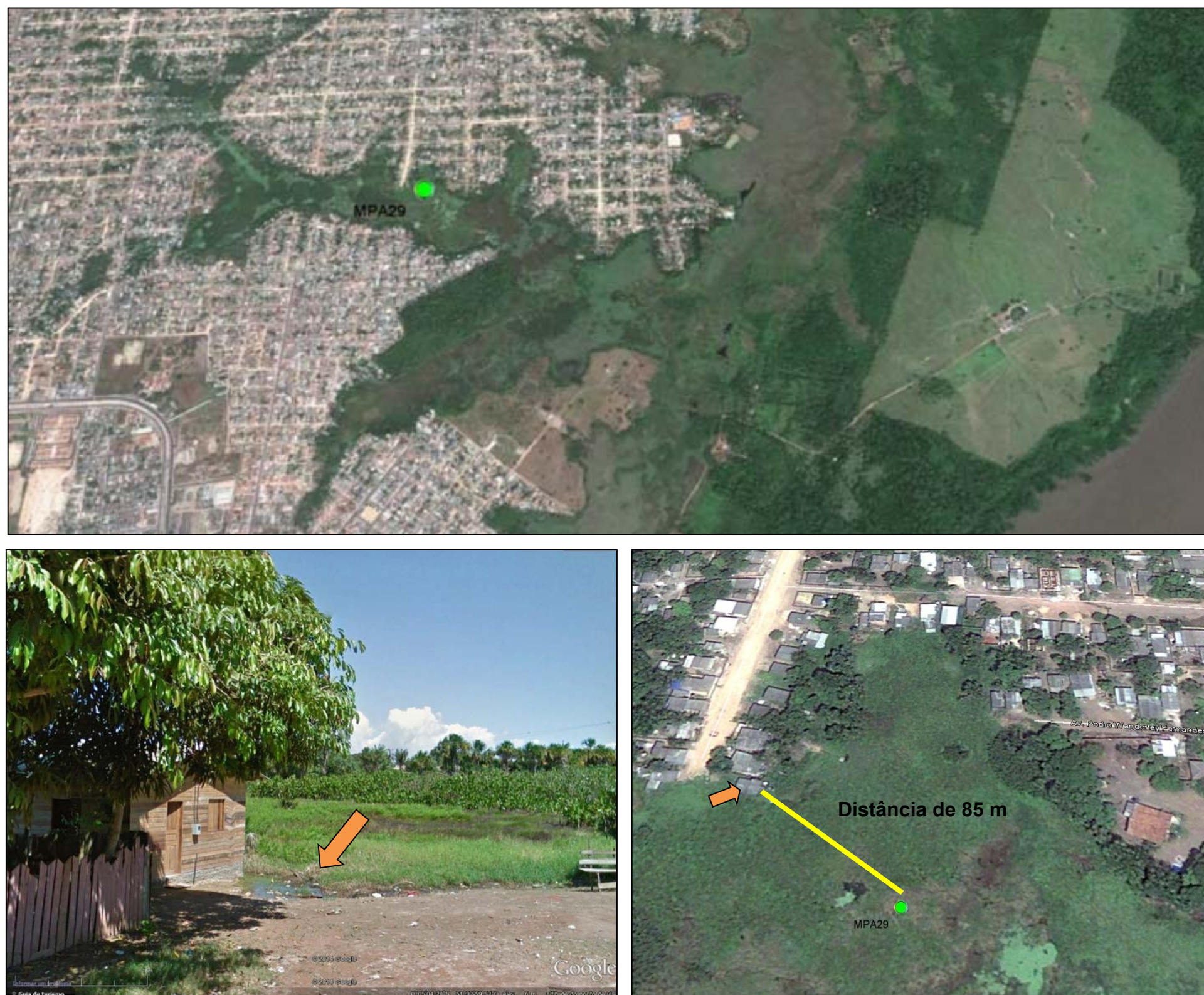
Foto 6.1 – Lançamento de esgoto in natura , em frente à residência situada a cerca de 85 m de distância do poço MPA29, no aquífero Tucunaré.
