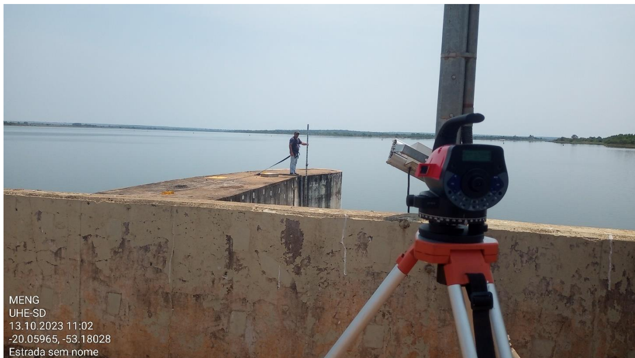
Figura 60 – Foto do nivelamento da régua do vertedor
