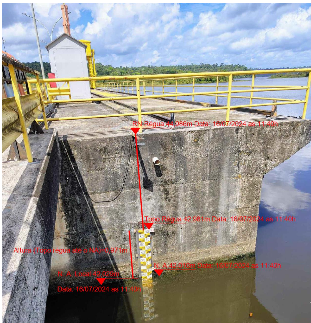
Figura 4.1.3.2 – Visualização das altitudes medidas por nivelamento geométrico em 16/07/2024 do RN e da Régua do Barramento da UHE Coaracy Nunes.
