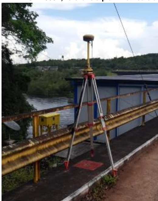
Figura 4.2 RN IBGE 1633L, referência planimétrica e altimétrica localizada no corpo da estrutura da Casa de Força.
