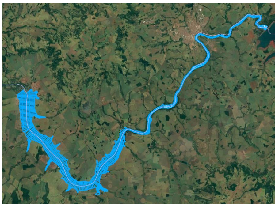
Figura 35 - Planejamento das Seções Batimétricas.
