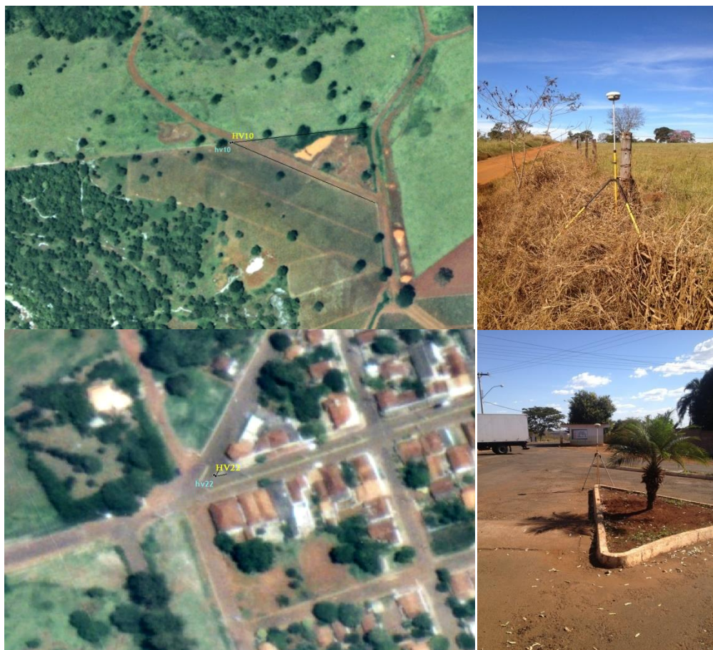
Figura 33 - Pontos de Controle de Qualidade: CAMPO x BASE CARTOGRÁFICA (em amarelo medição GNSS 2015, em azul mapeamento 2003)
