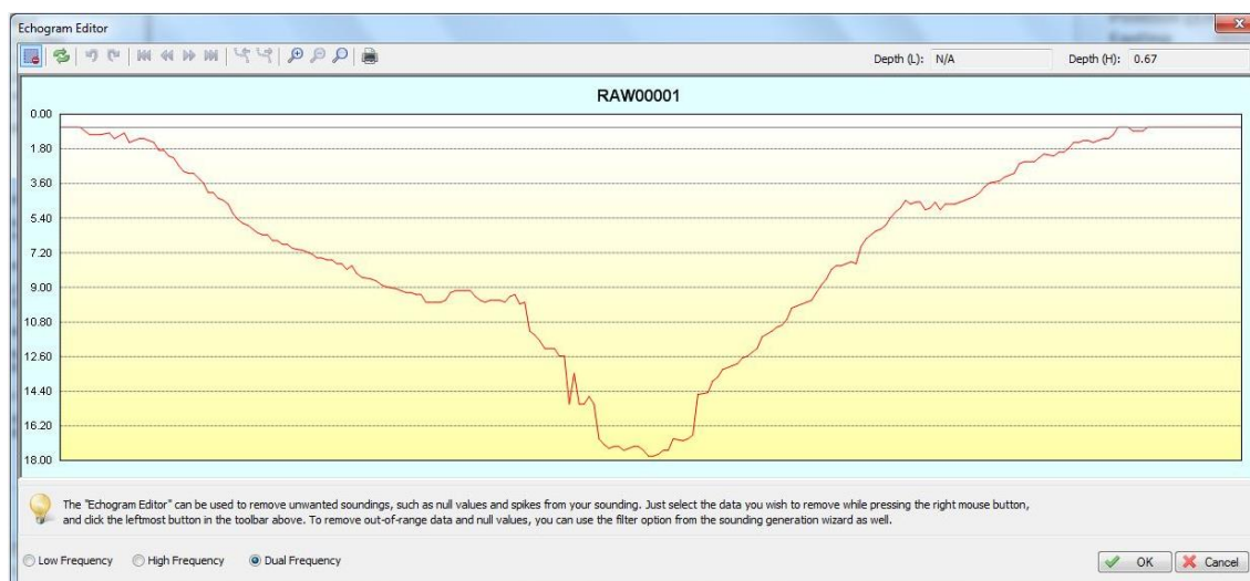
Figura 50 - Exemplo de Seção bruta com spike.
