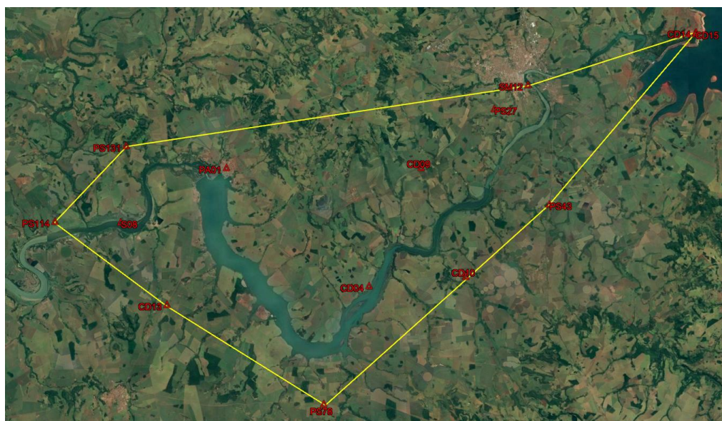
Figura 26 - Vértices do Modelo Geoidal Local.
