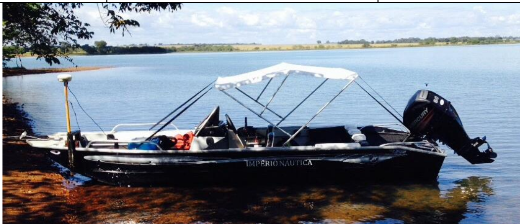
Figura 39 - Conjunto RTK / Ecobatímetro / Embarcação.
