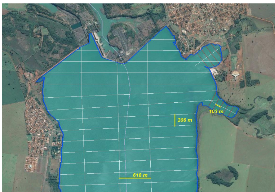
Figura 36 - Distanciamento entre as Seções Batimétricas.
