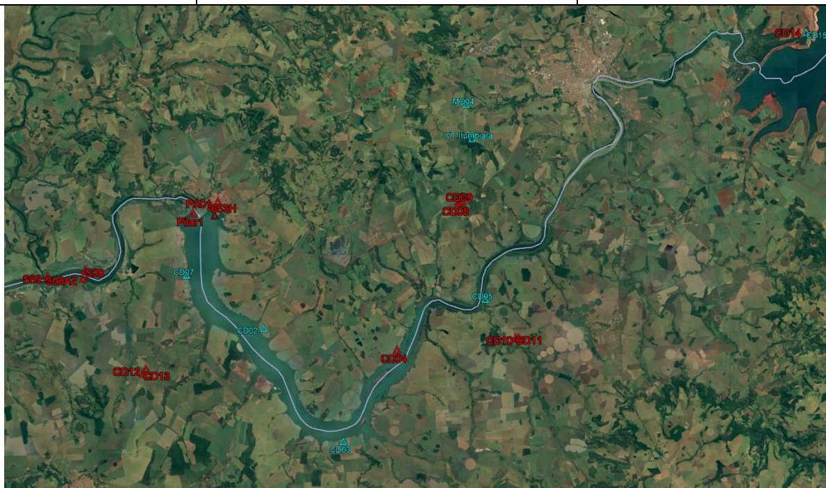
Figura 7 - RVG, Vértices nivelados geometricamente (em vermelho) e não nivelados (em azul).
