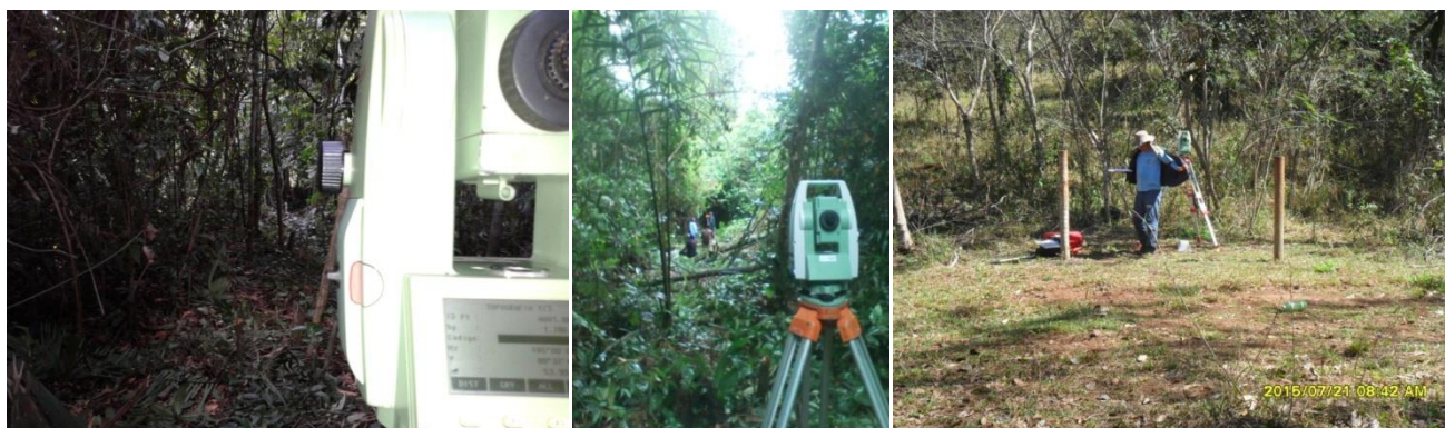
Figura 76 - Levantamento de Seções Topobatimétricas de Controle com Estação Total.
