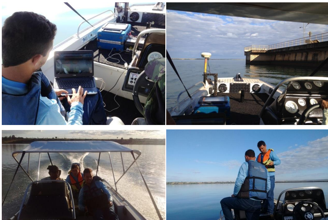
Figura 43 - Execução do Levantamento Batimétrico.
